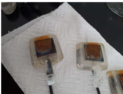
Slika 1. Izgled uzorak ugljičnog čelika prije ispitivanja
