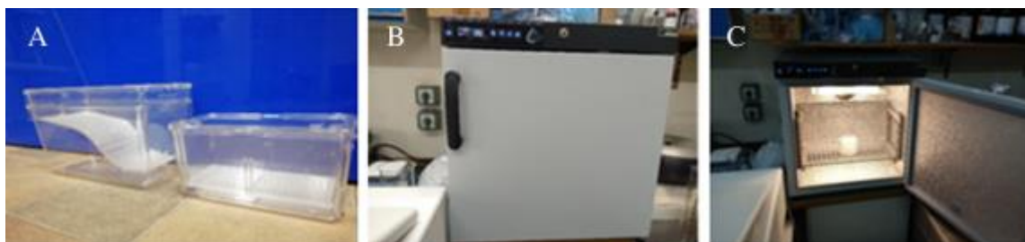
Slika 17. Prikaz (A) mrijestilica i (B i C) inkubatora za oplodnju i razvoj embrija ribe zebrice.
