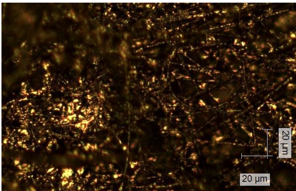
Slika D12. MetB ( c = 1 \times 10^{-4} \text{ mol dm}^{-3} ) na staklenom filter-papiru tretiranom s AgNP, snimano pod objektivom uvećanja \times 20
