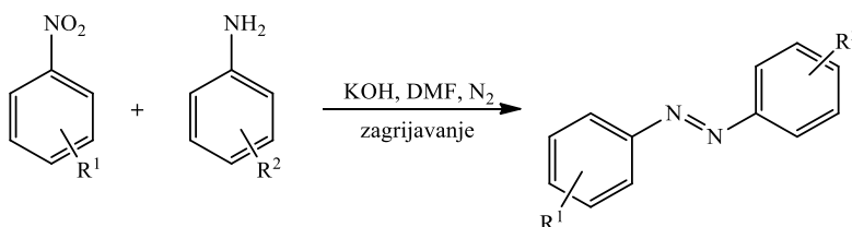
Slika 18. Reakcija supstituiranih anilina i supstituiranih nitrobenzena
