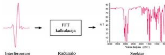
Slika 7. Shematski prikaz dobivanja odgovarajućeg spektra korištenjem Fourierove transformacije 58
