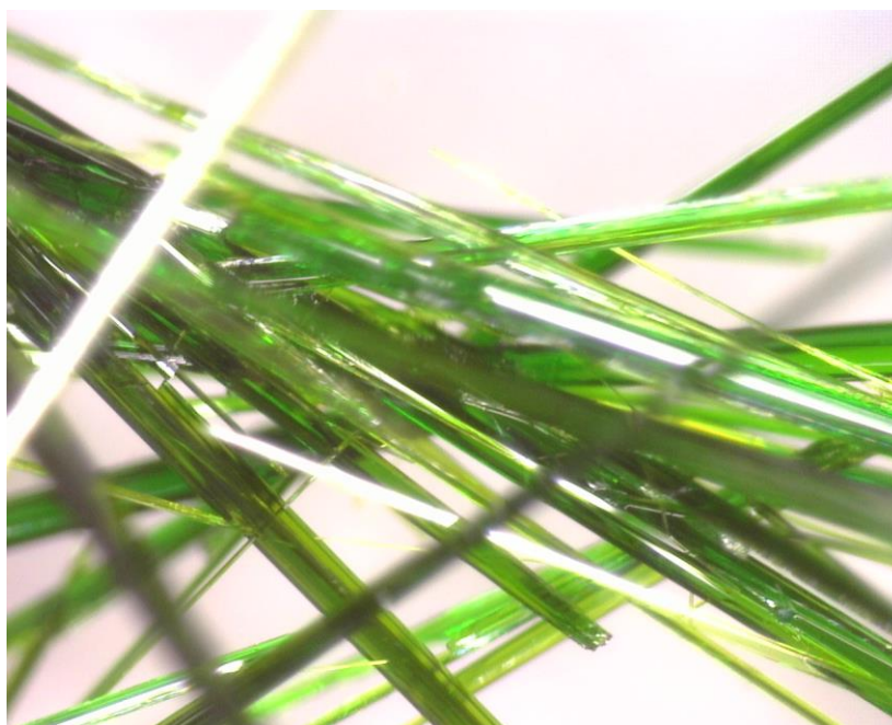
Slika 14. Zeleni igličasti kristali jediničnog spoja [\text{CuBr}_2(\text{isn})_2]_n (2)
