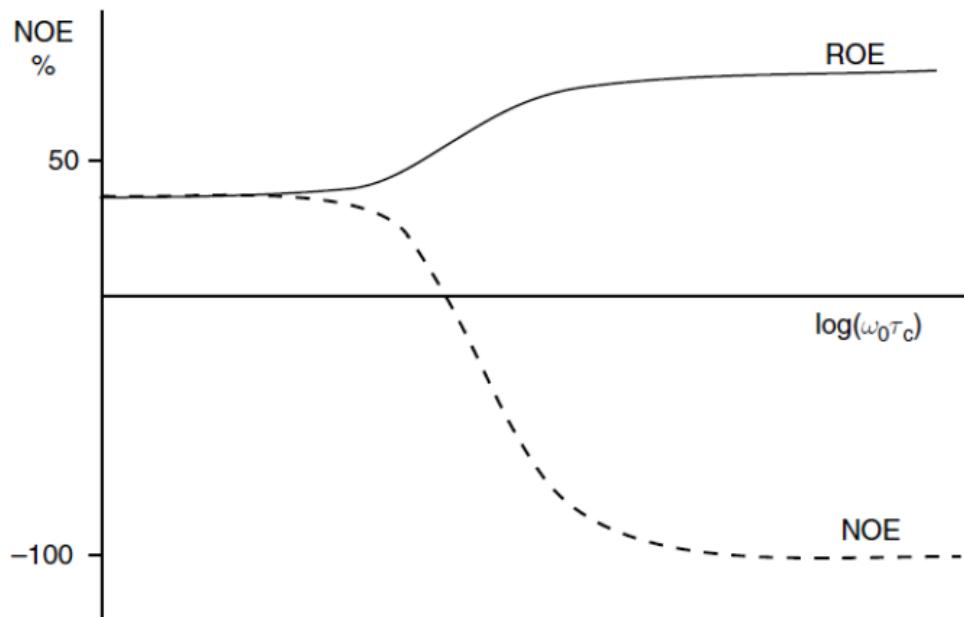
Slika 10. Ovisnost intenziteta signala NOESY i ROESY o logaritmu umnoška frekvencije vanjskog polja i korelacijskog vremena.<sup>35</sup>
