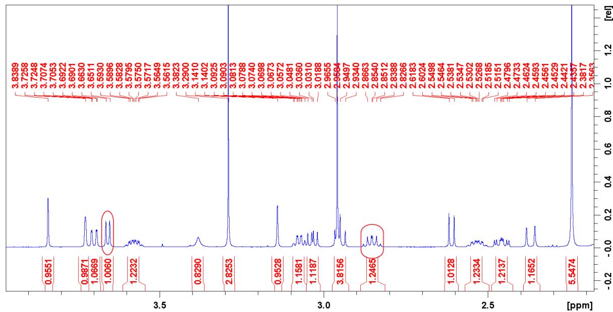
Slika 26. Uvećani dio spektra <sup>1</sup>H NMR klaritromicina snimljenog u acetonitrilu-d<sub>3</sub>. Crvenom bojom označeni su signali protona u položajima 2 i 3 sa spregom karakterističnom za konformaciju *folded-out*.
