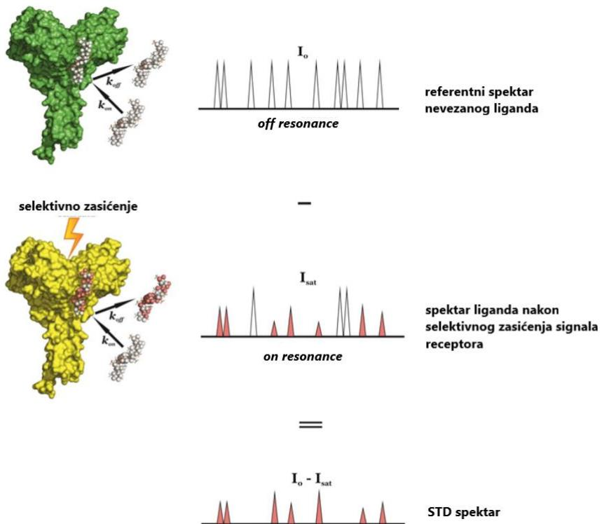
Slika 8. Princip eksperimenta STD NMR i dobivanje spektra STD oduzimanjem spektra *on-resonance* od spektra *off-resonance*. A) Spektar *off-resonance* prikazuje signale liganada u bez selektivne pobude protona receptora. B) Spektar *on-resonance* dobiven uz selektivnu pobudu protona receptora. C) Razlika daje spektar STD gdje su prisutni signali samo vezanih liganda, a njihov intenzitet ovisi o prostornoj udaljenosti od veznog mesta receptora.<sup>34</sup>
