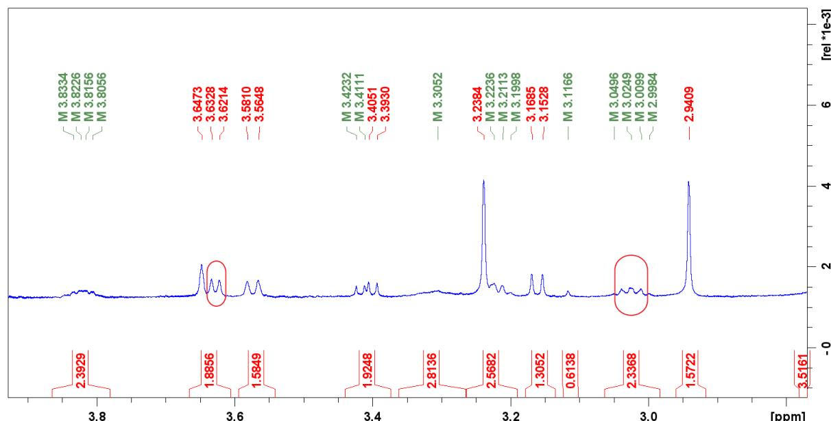
Slika 32. Uvećani dio <sup>1</sup>H NMR spektra klaritromicina snimljenog u D<sub>2</sub>O. Crvenom bojom označeni su signali protona u položajima 2 i 3 sa spregom karakterističnom za konformaciju *folded-out*.
