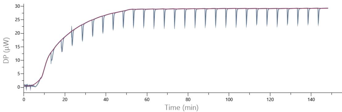
Slika 20. Termogram dobiven titracijom otopine ribosoma ( $c = 4 \mu\text{mol L}^{-1}$ ) i peptida PrAMP ( $c = 200 \mu\text{mol L}^{-1}$ ) otopinom 3-*O*-aminopropil-azitromicina ( $c = 135 \mu\text{mol L}^{-1}$ ).
