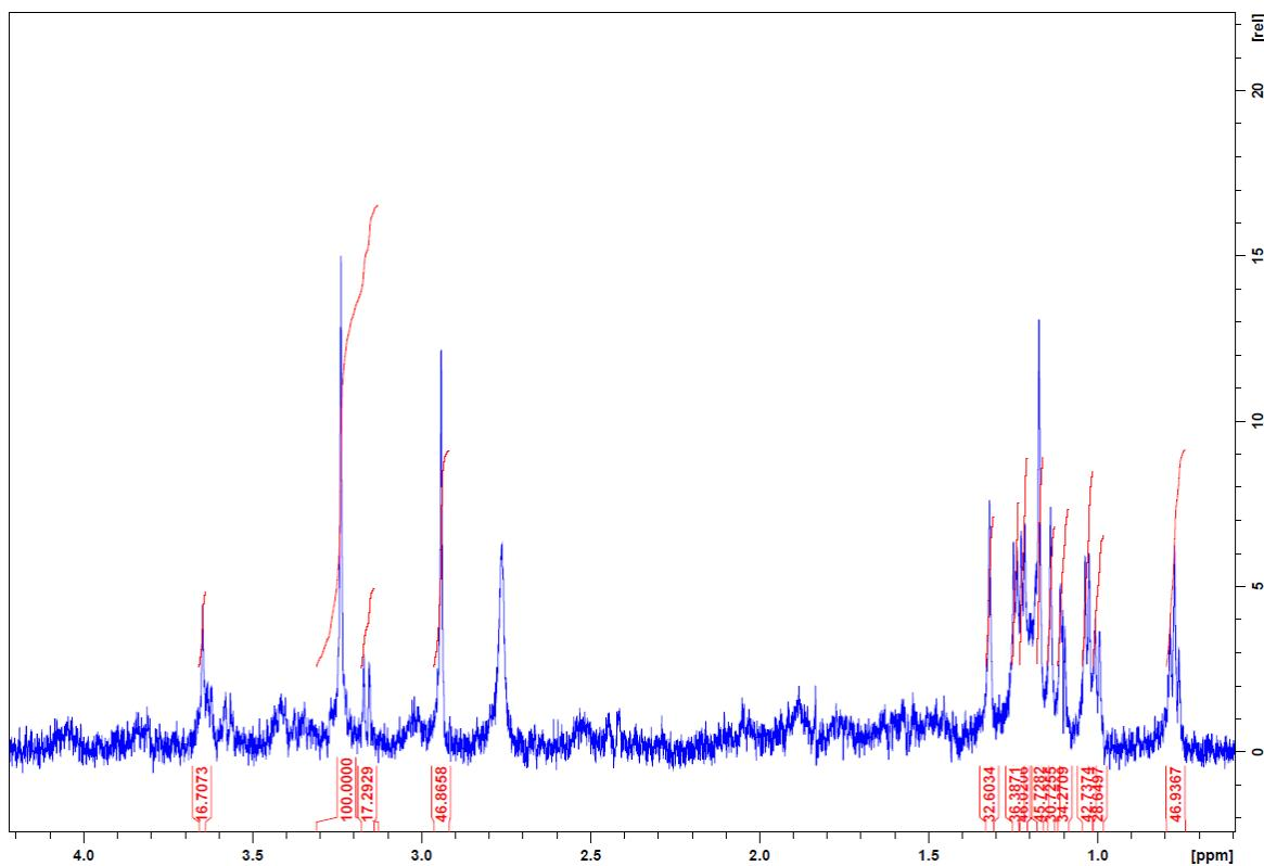
Slika D13. Spektar STD NMR klaritromicina u  $\text{D}_2\text{O}$  s navedenim vrijednostima integrala.
