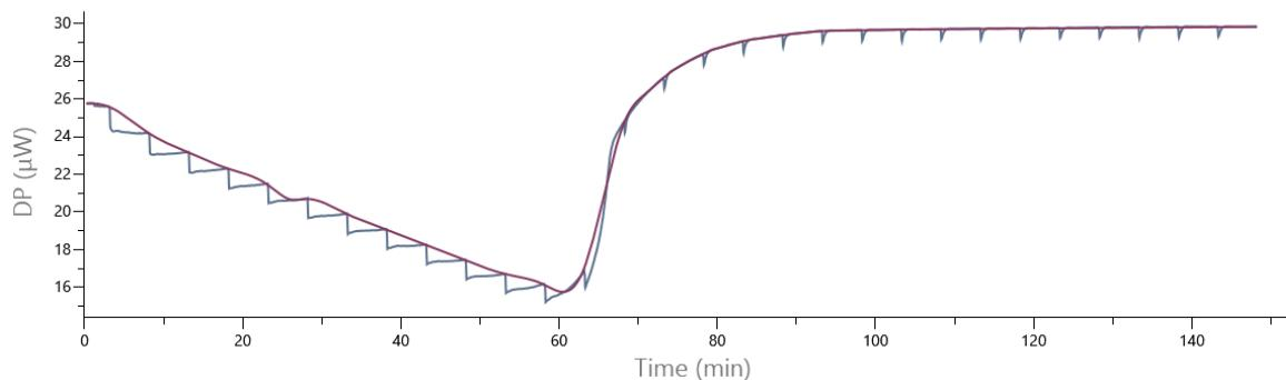
Slika 21. Termogram dobiven titracijom otopine 3-*O*-aminopropil-azitromicina ( $c = 1,35 \mu\text{mol L}^{-1}$ ) i peptida PrAMP ( $c = 200 \mu\text{mol L}^{-1}$ ) otopinom ribosoma ( $c = 14,8 \mu\text{mol L}^{-1}$ ).
