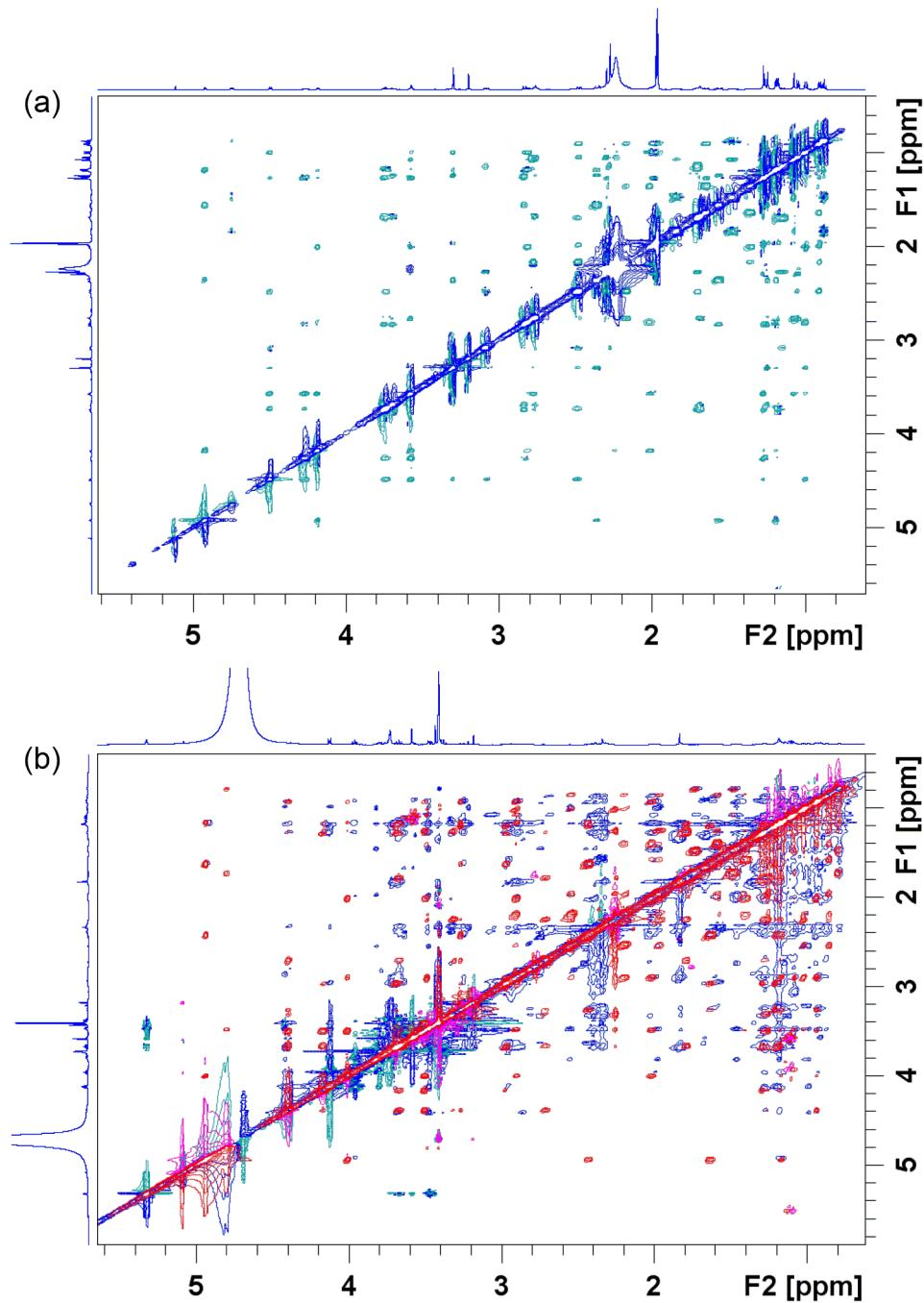
Slika 11. a) Spektar NOESY 4"-aminopropil-azitromicina u acetonitrilu-d<sub>3</sub> prije dodatka ribosoma iz *E. coli*; b) spektar NOESY (ružičasti i crveni signali) i trNOESY (plavi i zeleni signali) istog spoja u puferu tris-d<sub>11</sub> prije odnosno nakon dodatka ribosoma iz *E. coli*.<sup>4</sup>
