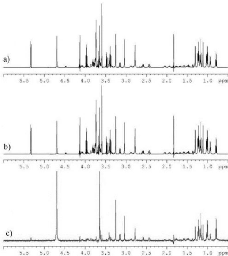
Slika 9. a) Spektar *on-resonance* oleandomicina b) spektar *off-resonance* oleandomicina nakon dodatka ribosoma (50 ppm) c) spektar STD oleandomicina u puferu tris-d<sub>11</sub> pri 25 °C.<sup>2</sup>
