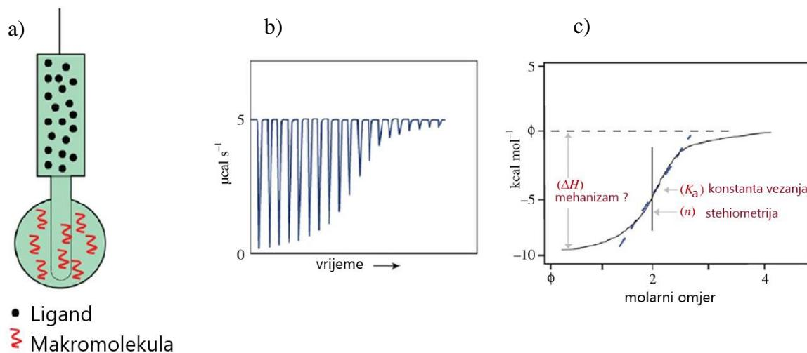
Slika 13. a) Shematski prikaz receptora u reakcijskoj ćeliji i molekula liganda u injekcijskoj štrejaljci. b) Termogram: dijagram ovisnosti primijenjene snage o vremenu i c) titracijska krivulja. Parametri  $K_a$ ,  $n$  i  $\Delta H$  mogu se izravno očitati iz titracijske krivulje.<sup>37</sup>
