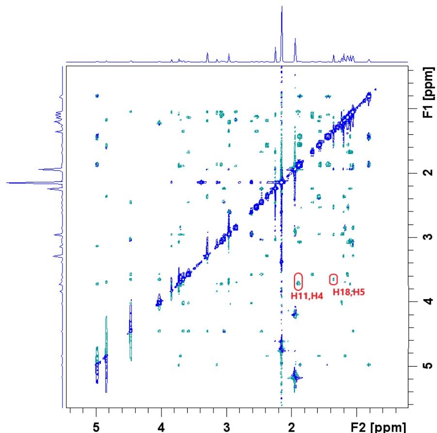
Slika 24. Spektar NOESY klaritromicina u acetonitrilu-d<sub>3</sub>. NOE kontakti karakteristični za konformaciju *folded-out* zaokruženi su i označeni crvenom bojom.
