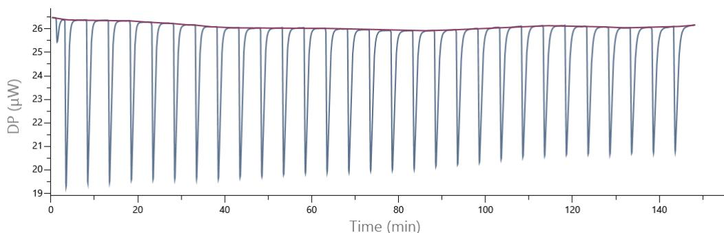
Slika 18. Termogram dobiven titracijom otopine ribosoma ( $c = 14,8 \mu\text{mol L}^{-1}$ ) i peptida PrAMP ( $c = 200 \mu\text{mol L}^{-1}$ ) otopinom 3-*O*-aminopropil-azitromicina ( $c = 135 \mu\text{mol L}^{-1}$ ).
