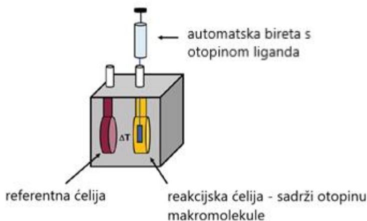
Slika 12. Shematski prikaz izotermnog titracijskog kalorimetra.<sup>39</sup> autom bireta
