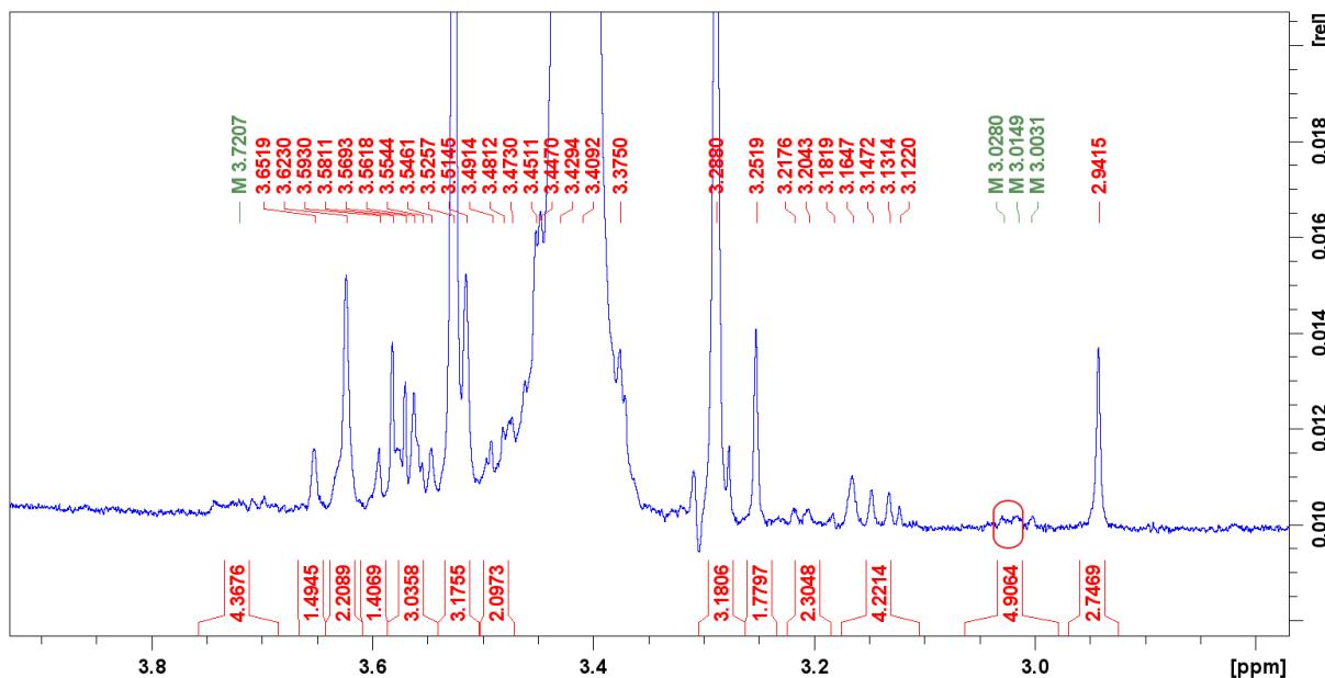
Slika 33. Uvećani dio  $^1\text{H}$  NMR spektra klaritromicina snimljenog u puferu tris-d<sub>11</sub>. Crvenom bojom označeni su signali protona u položajima 2 i 3 sa spregom karakterističnom za konformaciju *folded-out*.
