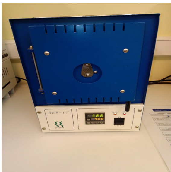
Slika 3.8: Peć za aniliranje dozimetara.
