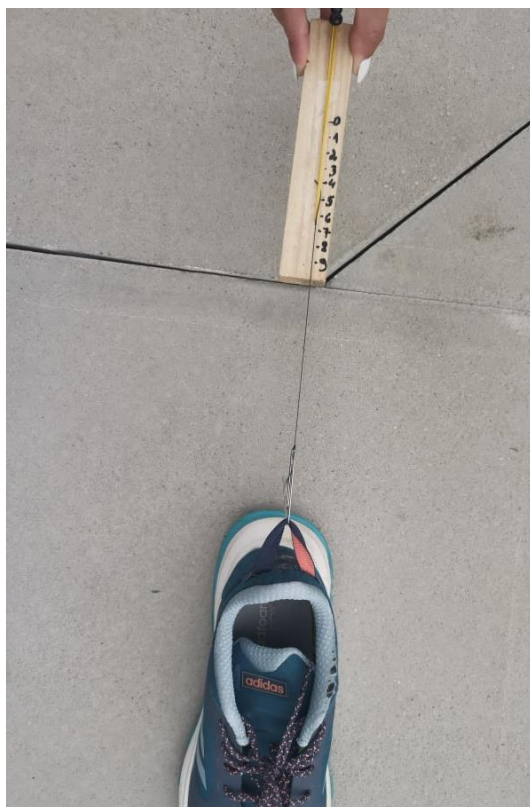
Slika 13. Mjerenje sile pri gibanju tenisice jednakom brzinom
