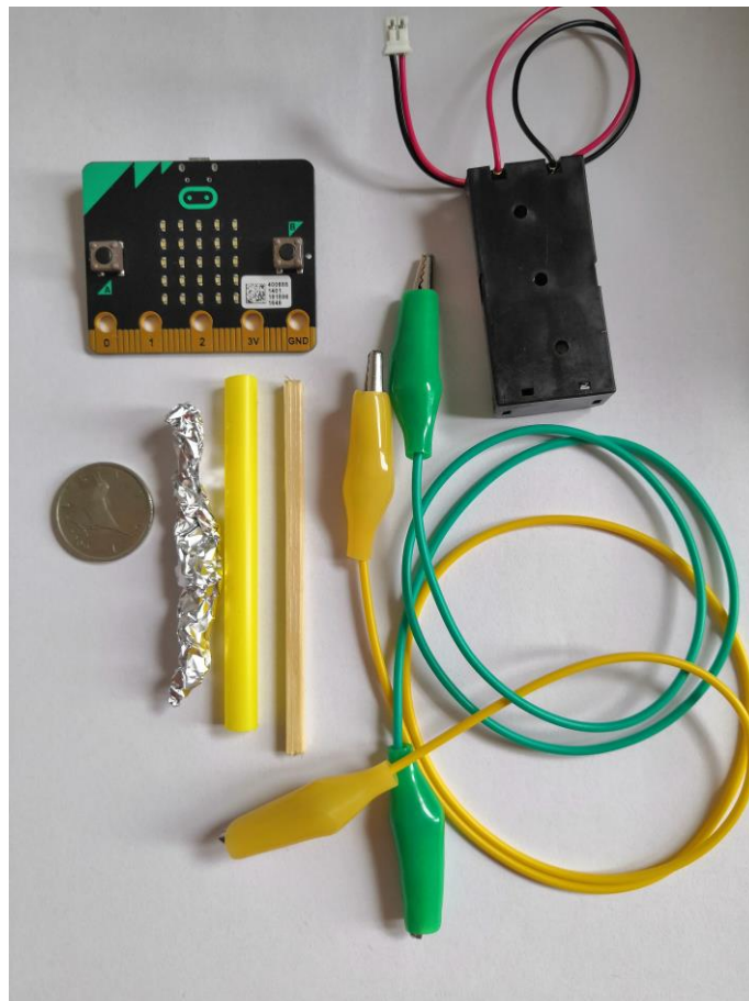
Slika 3.3 Eksperimentalni postav prije spajanja
