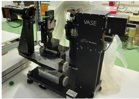
Slika 3.8: VASE J.A. Woolam elipsometar korišten u ovom radu
