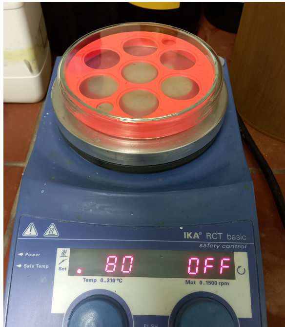
Slika 3.13: Proces silanizacije okruglih stakalca
