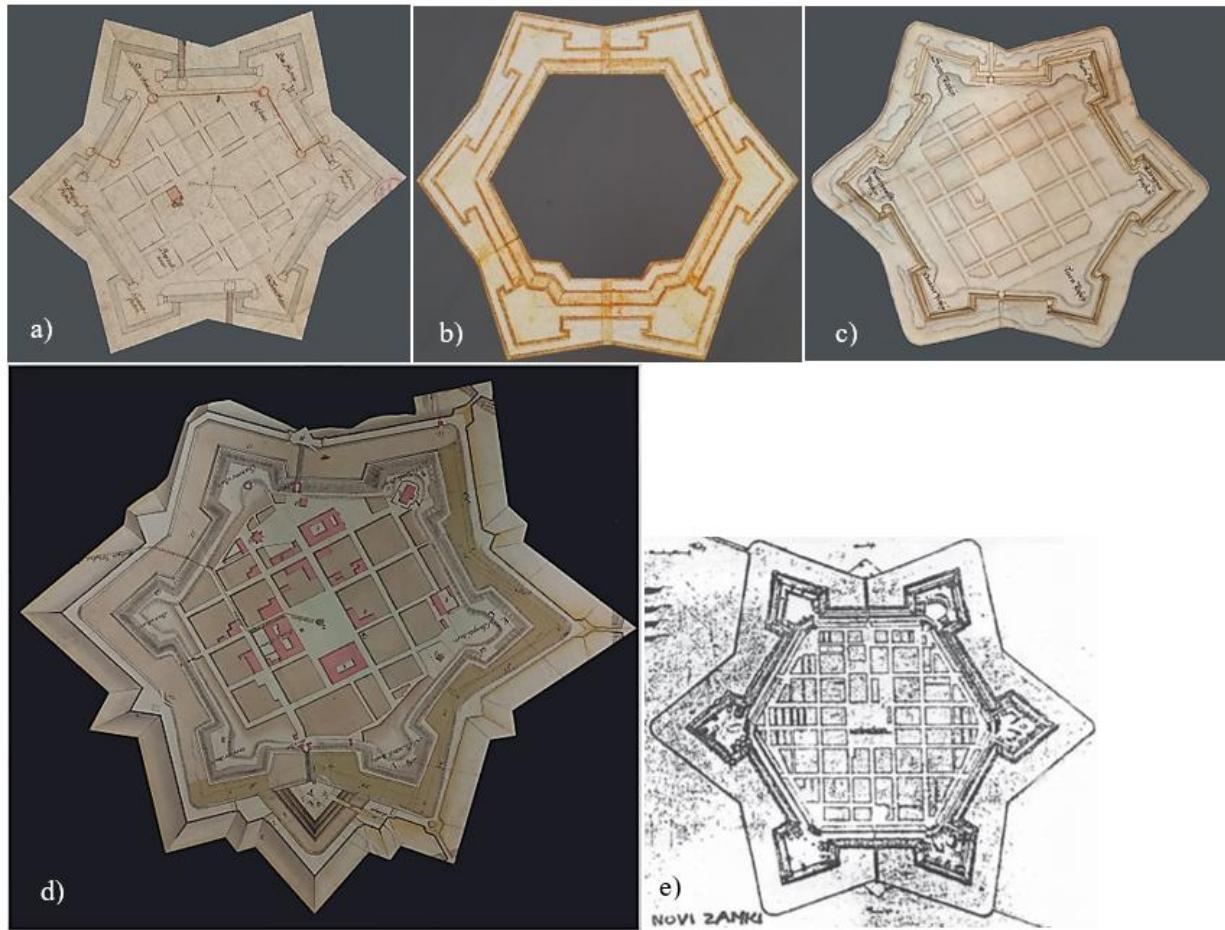
Sl. 3. Prvi idejni plan Zvijezde iz 1579. godine (a), Pieronijev prijedlog plana Zvijezde iz 1639. godine (b), Stierov situacijski plan iz 1660. godine (c), Plan iz 1766. godine sa novoizgrađenim ravelinom (d), Plan Érsekújvára ili Nové Zámky (e)
