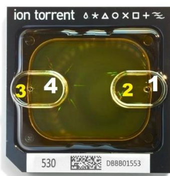
Slika 9. Ion 530™ čip; Brojevi označavaju otvor (1) i bazenčić za nanošenje (2) te izlazni otvor (3) i izlazni bazenčić (4) (preuzeto sa https://www.thermofisher.com/order/catalog/product/A27763#/A27763 )
