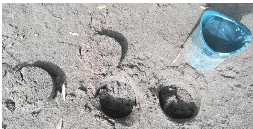
Slika 9. Uzorkovanje sedimenta metalnim cilindrom
