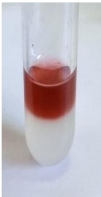
Slika 103. MeCN gel spoja 17 nadslojen otopinom Grubbsovog katalizatora II. generacije.
