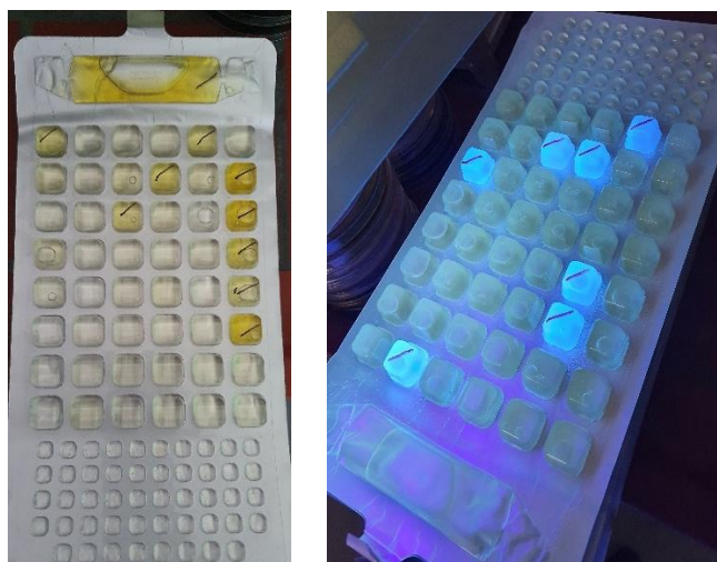
Slika 18. Colilert-18 test: žute komorice ukazuju na ukupne koliforme, a fluorescentne komorice pod UV svjetlom ukazuju na E. coli
