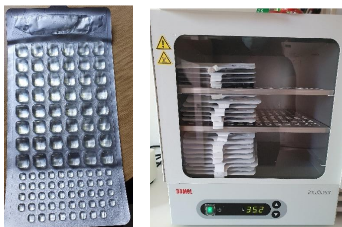
Slika 17. Uzorci u komoricama pripremljeni za inkubaciju te njihova inkubacija u inkubatoru na 35 °C
