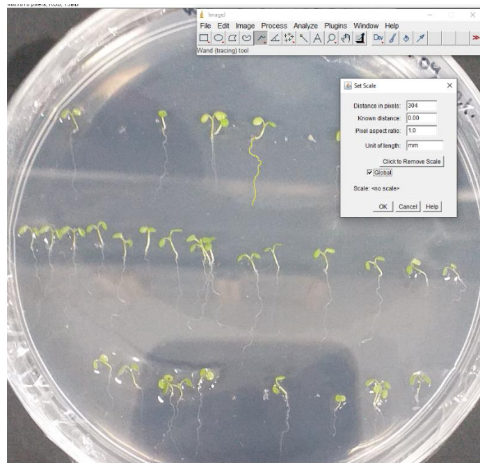
Slika 4. Prikaz mjerenja duljine korijena u programu ImageJ, na jednoj fotografiji, gdje je netom određena mjerna skala u milimetrima
