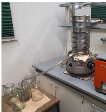
Slika 10. Standardna Retsch ASTM sita na Fritchs Analysette tresilici, Geološko-paleontološki zavod PMF-a.
