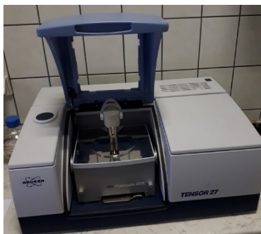
Slika 17. Tensor 27 spektrometar za snimanje FTIR spektra u ATR-u, Mineraloško-petrografski zavod PMF-a.
