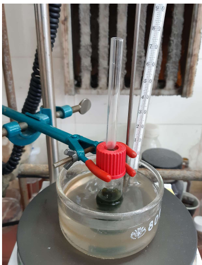
Slika 32. Prikaz aparature korištene za reakciju sinteze 2-fenilkinoksalina
