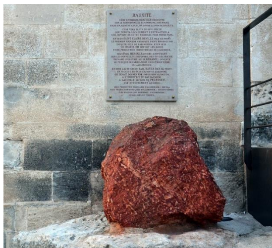
Slika 1: Primjer boksita iz Les Baux u Francuskoj (preuzeto sa Internetski izvor 1)
