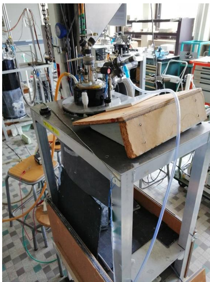
Slika 22. Mössbauerov spektrometar za analizu uzoraka pri sobnoj temperaturi i temperaturi od 77 K na Institut des Molécules et Matériaux (IMMM) u Republici Francuskoj
