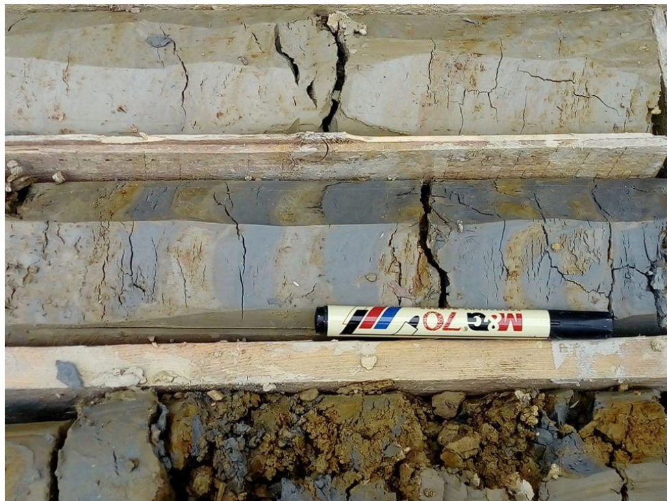
Slika 3.7. Proslojavanje svjetlijih smečkastih i tamnijih sivih slojeva u drugom intervalu između 6. i 7. metra. Donji dio predstavlja interval razlomljene jezgre oko 8. metra. Dimenzije markera: 14,5 cm x 1 cm.
