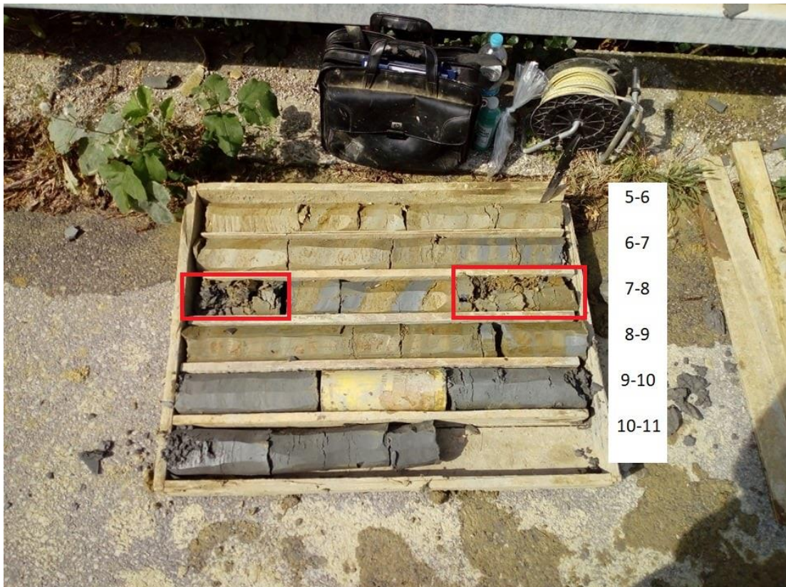
Slika 3.5. Prikaz jezgri iz drugog intervala između 5 i 11 metara. Brojevi predstavljaju dubinu uzorkovanja u metrima [m] dok crveni pravokutnici označavaju razlomljene intervale između 7. i 8. metra.
