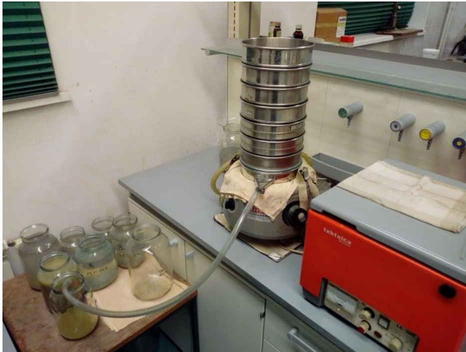
Slika 3.13. Set sita koja su korištena u određivanju granulometrijskog sastava. Lijevo na stolu su vidljive posude u kojima se nalazi suspenzija s frakcijom koja je prošla kroz sito s otvorima veličine 0,063 milimetara.
