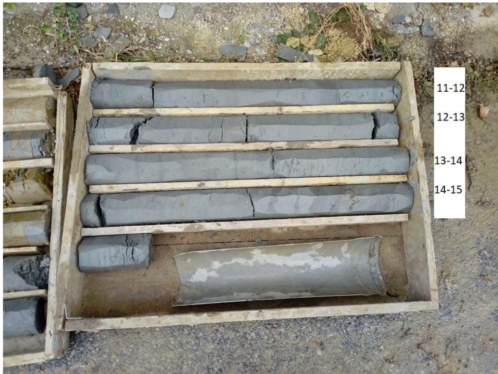
Slika 3.6. Bušotinske jezgre iz trećeg intervala između 11 i 15 metara. Brojevi predstavljaju dubinu uzorkovanja u metrima [m].
