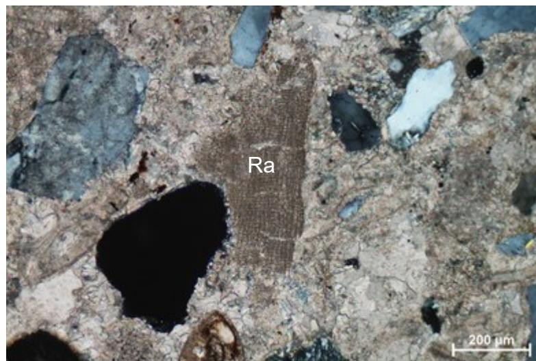
Slika 16. Fragment crvene tipične „mrežaste“ strukture (Ra) (analizator uključen).
