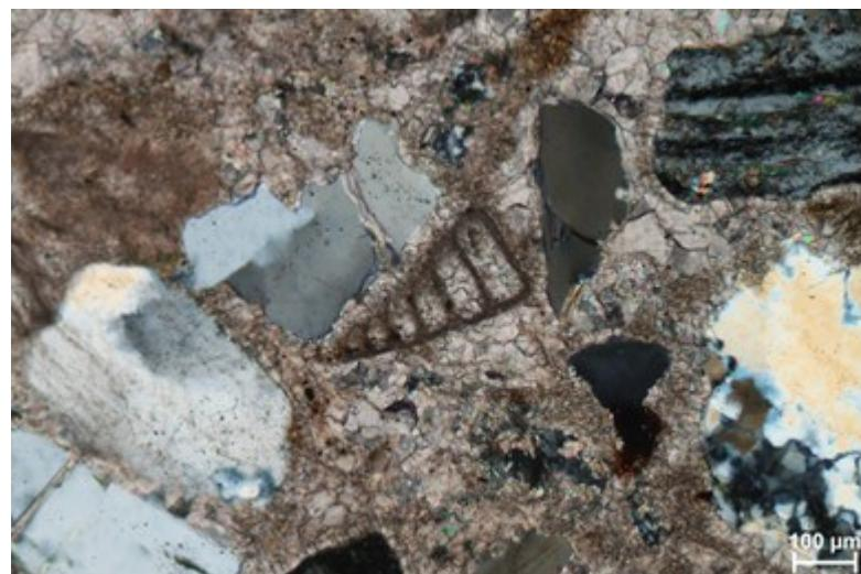
Slika 18. Fosilni ostatak bentičke foraminifere (F) (analizator uključen).
