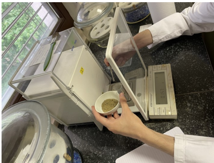
Slika 8. Vaganje praškastog uzorka za analizu sadržaja CaCO 3 .
