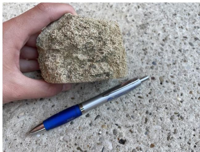
Slika 6. Uzorak čvrsto litificiranog pješčenjaka uzet za laboratorijska istraživanja.
