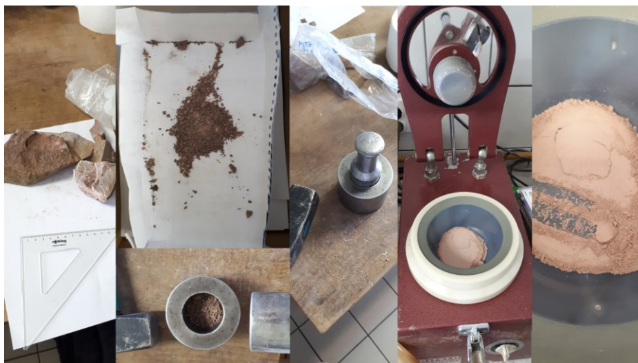
Slika 7. Slijed usitnjavanja uzorka
