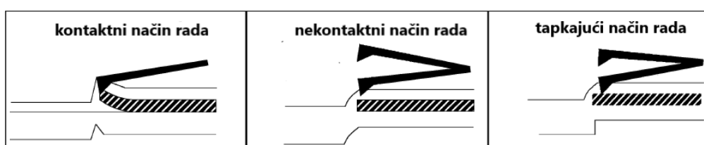
Slika 10. Načini rada AFM-a. Slika je preuzeta i doradena iz reference 41.
