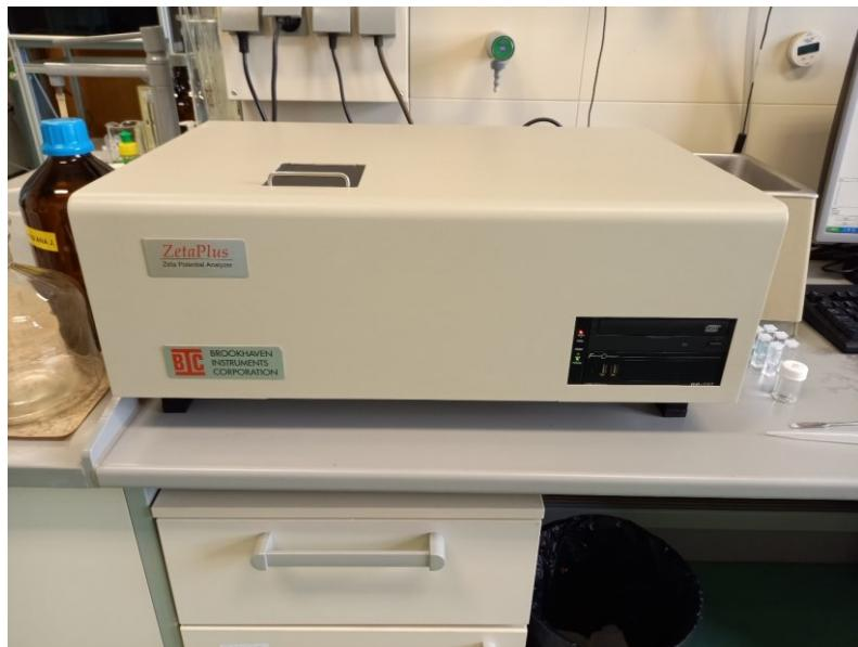
**Slika 13.** Uredaj za dinamičko raspršenje svjetlosti Brookhaven 90 Plus Particle Size Analyzer (*Brookhaven Instruments Corporation*, Sjedinjene Američke Države).
