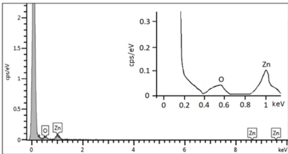
Slika 45: EDS mjerjenje na ZnO nanočestici (umetak: uvećan prikaz glavnih vrhova za O i Zn)
