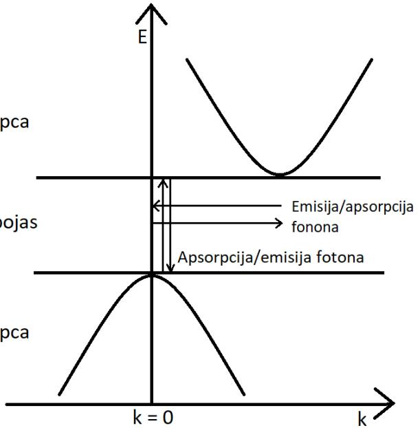
Slika 2: Sheme energijskog dijagrama za elektronske prijelaze u slučaju a) direktnog i b) indirektnog zabranjenog pojasa
