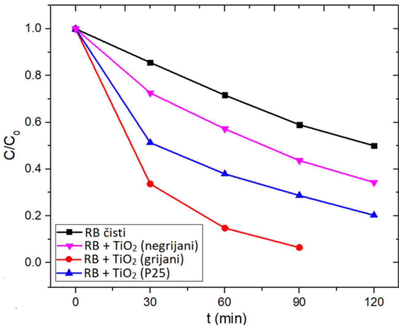
Slika 38: Ovisnost maksimuma vrha RB u UV-Vis o vremenu u fotokatalitičkim testovima za UV zračenje u slučajevima različitih katalizatora: a) bez katalizatora, b) grijanih  $\text{TiO}_2$  nanočestica i c) P25
