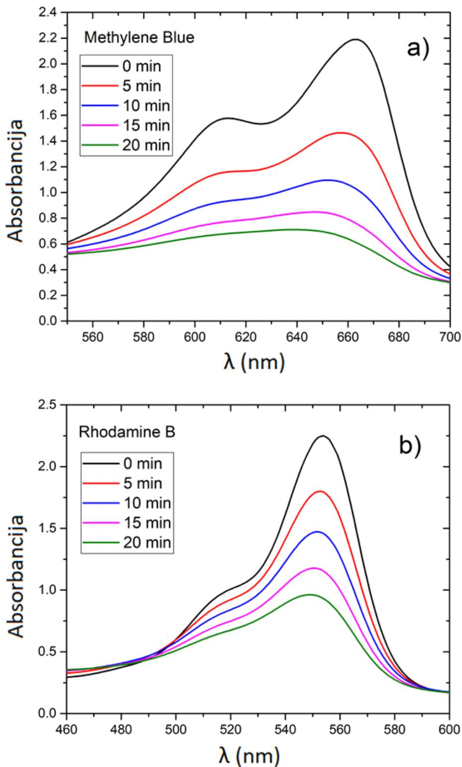
Slika 51: Fotodegradacija a) MB i b) RB u nerazrijedenoj koloidnoj otopini ZnO ( $C_{\text{ZnO}} = 100\%$ ) tijekom ozračivanja UV zračenjem
