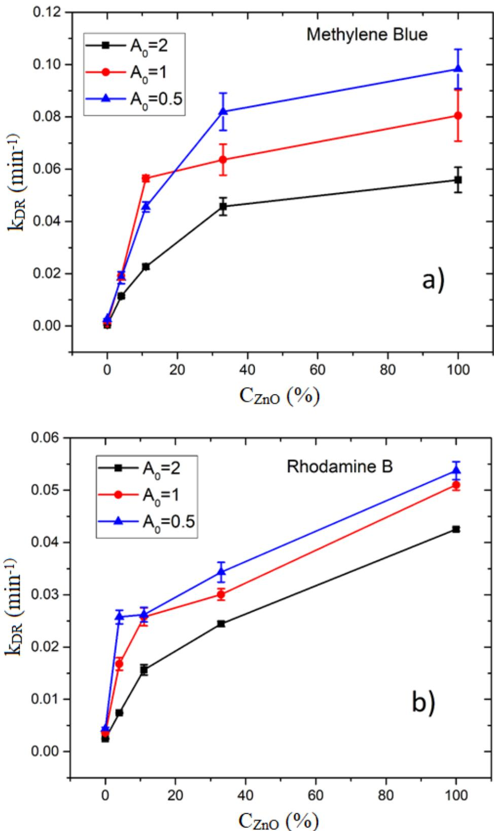
Slika 54: Fotodegradacijske konstante (k<sub>DR</sub>) za raspad a) MB i b) RB u ovisnosti o koncentraciji ZnO katalizatora za različite početne koncentracije bojila
