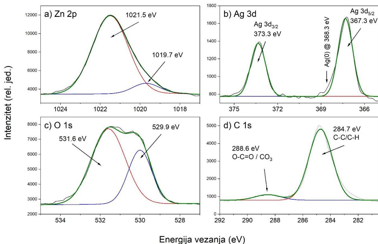
Slika 58: Visokorezolucijski spektri ZnO nanočestica dopiranih srebrom (3000 pulseva korišteno za depoziciju srebra u PLD) i prilagodbe za a) Zn 2p<sub>3/2</sub>, b) Ag 3d, c) O 1s i d) C 1s
