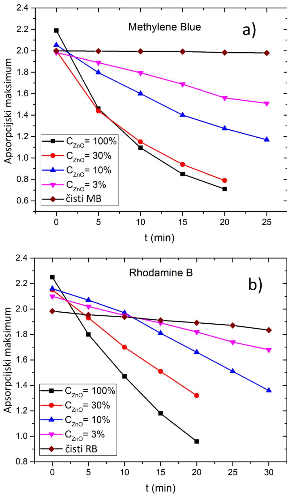
Slika 52: Ovisnost apsorpcijskog maksimuma a) MB i b) RB tijekom fotodegradacije za različite koncentracije ZnO katalizatora i početnu koncentraciju bojila koja odgovara  $A_0 = 2$
