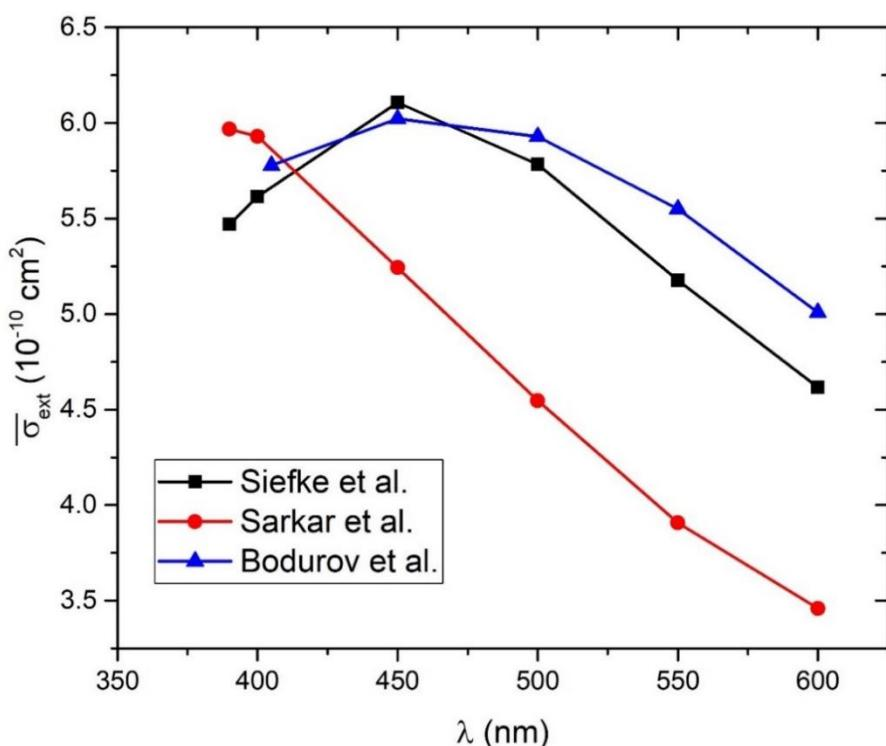
Slika 18: Ovisnost ekstincijskog udarnog presjeka o valnoj duljini izračunata iz Mieve teorije raspršenja za koloidnu otopinu sfernih  $\text{TiO}_2$  nanočestica u vodi, koristeći SEM distribuciju nanočestica po veličini iz Slike 15 i podatke o indeksima loma za  $\text{TiO}_2$  iz tri izvora: Siefke et al. [196], Sarkar et al. [197] i Bodurov et al. [198, 199]
