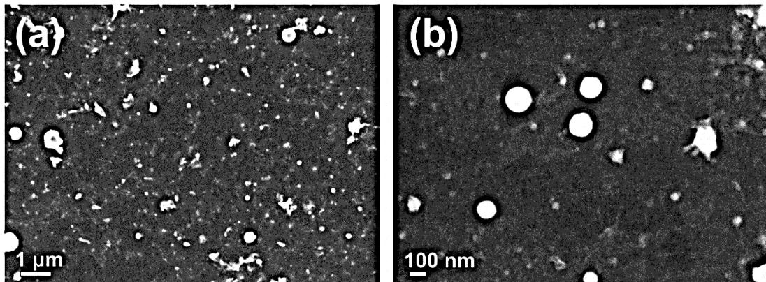
Slika 43: Primjeri SEM slika laserski sintetiziranih ZnO čestica: a) rezolucija 12x9  $\mu\text{m}$  – detaljan pregled sintetiziranih ZnO struktura, b) rezolucija 2x1.5  $\mu\text{m}$  – sferne ZnO nanočestice
