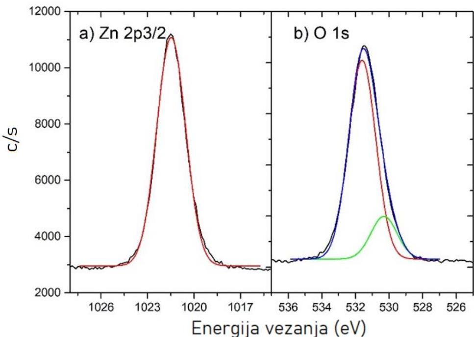
Slika 48: Visokorezolucijski XPS spektar sintetiziranih ZnO nanočestica i prilagodbe za a) Zn 2p<sub>3/2</sub> i b) O 1s
