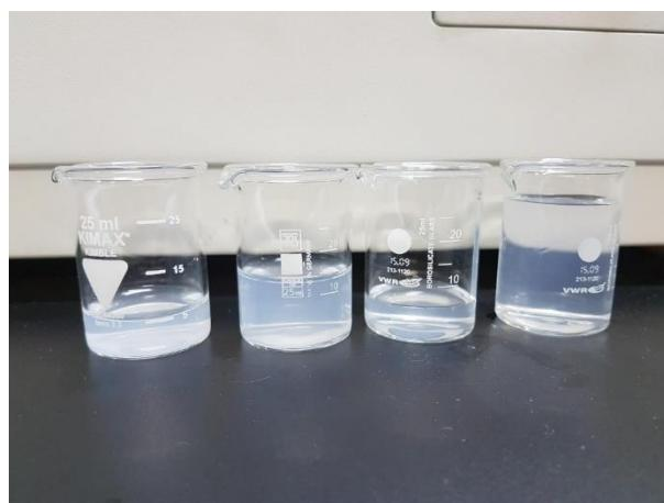
Slika 9 – Koloidne otopine  $\text{ZnO}$  nanočestica: razrijeđene otopine s 3%, 10% i 30% masene koncentracije  $\text{ZnO}$  (s desna na lijevo) u odnosu na masenu koncentraciju laserski sintetizirane koloidne otopine (skroz lijevo)
