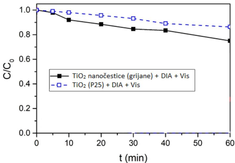
Slika 41: Ovisnost koncentracije Diazepama o vremenu u fotokatalitičkim testovima za ozračivanje vidljivim svjetлом u prisutnosti grijanih  $\text{TiO}_2$  nanočestica i P25 kao katalizatora
