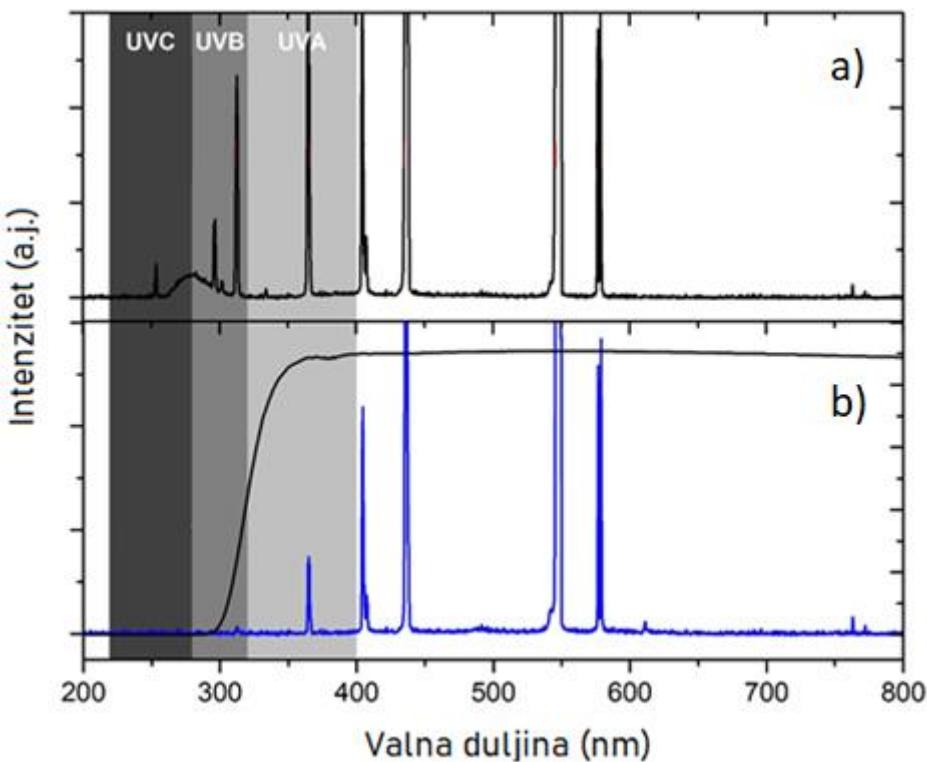
Slika 12: Spektar Hg lampe korišteni u fotokatalitičkim eksperimentima: a) bez staklenog filtera i b) sa staklenim filterom (donji graf)
