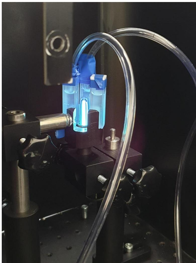
Slika 13: Otopine MB s  $\text{TiO}_2$  nanočesticama kao katalizatorom ozračivane svjetlošću Hg lampe u svrhu mjerjenja fotodegradacije MB i određivanja fotokatalitičke aktivnosti  $\text{TiO}_2$  nanočestica
