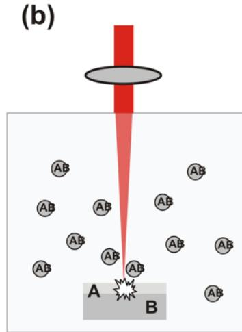
Slika 10: a) Sinteza filma od materijala A na supstratu B pulsnom laserskom depozicijom; b) Sinteza bikomponentnih nanočestica A/B laserskom ablacijom mete proizvedene u a; U ovom radu: A – srebro, B – cinkov oksid, A/B – ZnO dopiran srebrom
