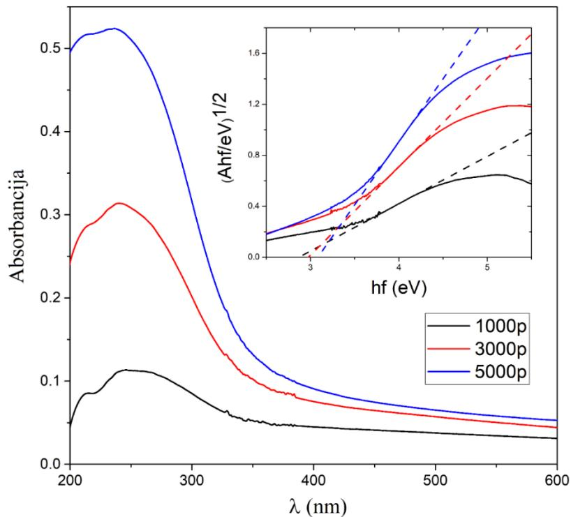
Slika 17: Fotoapsorpcijski UV-Vis spektri  $\text{TiO}_2$  koloidnih otopina za svaki broj pulseva; Umetak: Grafovi za izračun indirektne zabranjene zone Taucovom metodom iz pripadnih fotoabsorpcijskih krivulja
