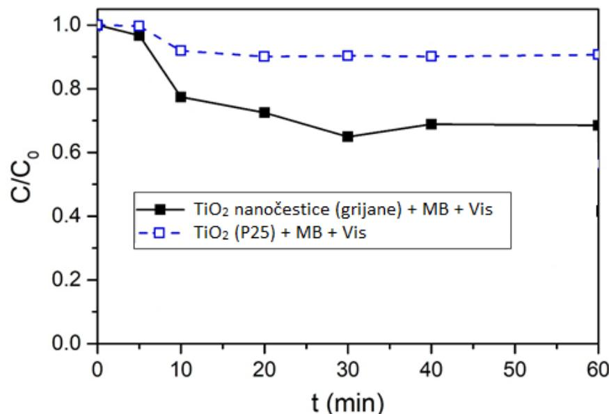
Slika 40: Ovisnost koncentracije Methylene Blue o vremenu u fotokatalitičkim testovima za ozračivanje vidljivim svjetlom u prisutnosti grijanih  $\text{TiO}_2$  nanočestica i P25 kao katalizatora
