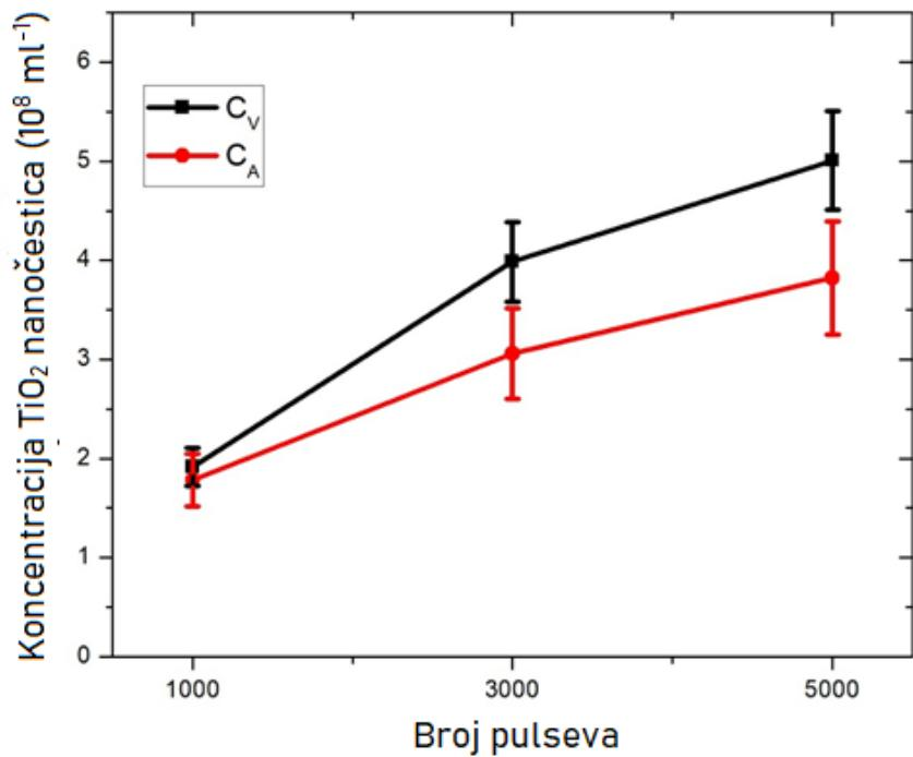
Slika 20: Ovisnost koncentracije  $\text{TiO}_2$  nanočestica u koloidnim otopinama o broju pulseva, za dva različita načina računanja koncentracije: preko volumena kratera ( $C_V$ ) i preko absorbancije ( $C_A$ )
