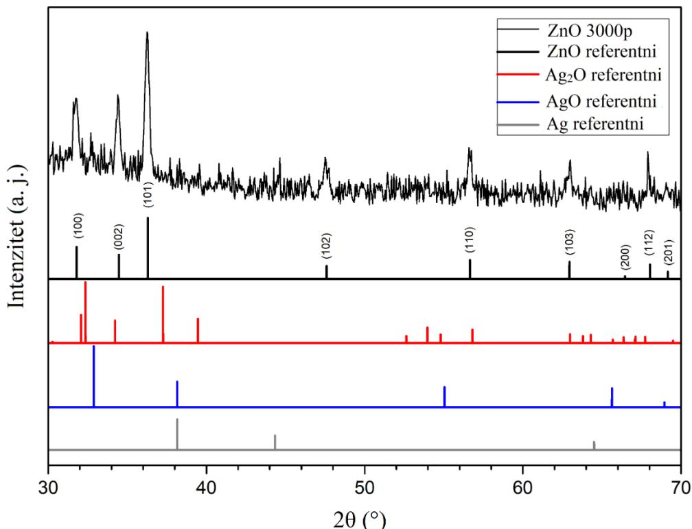
Slika 56: XRD spektar ZnO nanočestica dopiranih srebrom (3000 pulseva korišteno za depoziciju srebra u PLD) i referentni XRD spektralni vrhovi za ZnO, Ag, AgO i Ag<sub>2</sub>O
