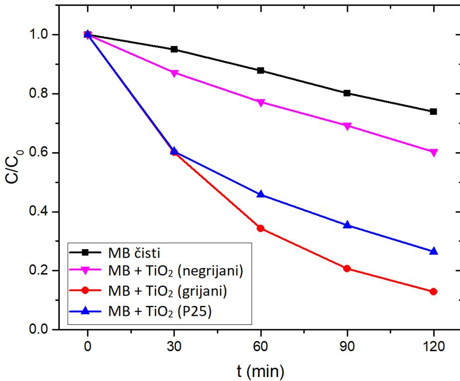
Slika 32: Ovisnost maksimuma vrha MB u UV-Vis o vremenu u fotokatalitičkim testovima za UV zračenje u slučajevima različitih katalizatora: a) bez katalizatora b) negrijanih TiO<sub>2</sub> nanočestica, c) grijanih TiO<sub>2</sub> nanočestica i d) P25
