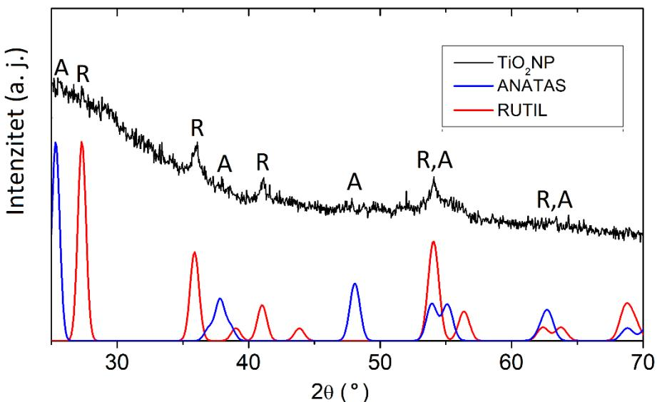
Slika 21: XRD spektar grijanih  $\text{TiO}_2$  nanočestica i referentni spektri za rutil i anatas
