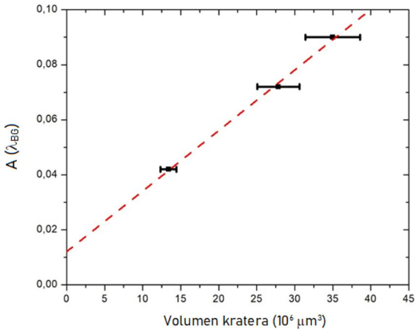
Slika 19: Ovisnost absorbancije na valnoj duljini zabranjene zone izmjerene Taucovom metodom o volumenu kratera preostalog na Ti meti nakon ablacija za svaku koloidnu otopinu  $\text{TiO}_2$  nanočestica zajedno s pripadnom linearnom prilagodbom.
