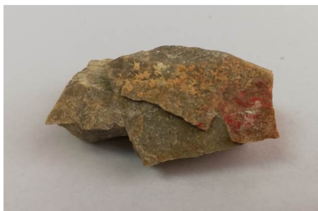
Slika 7. Uzorak dolomita sa sitnozrnastim agregatom cinabarita
