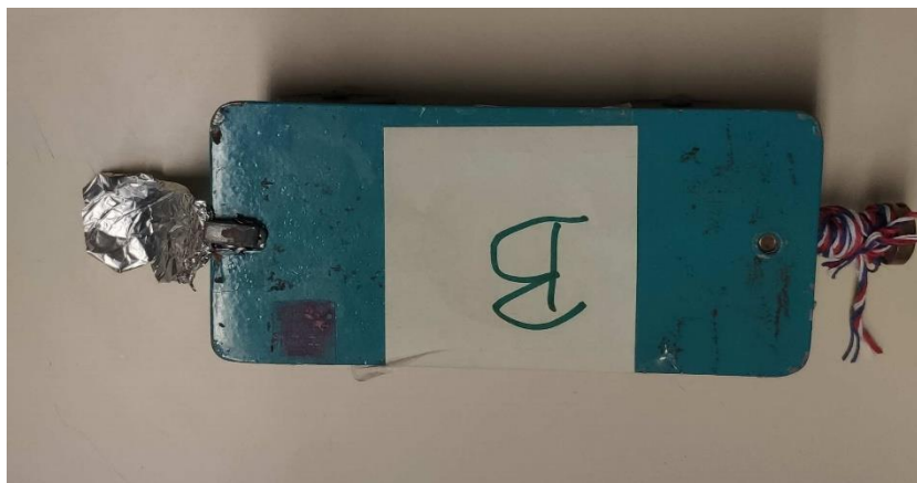
Slika 4.6 Spajanje vodljive vrpce na kolica
