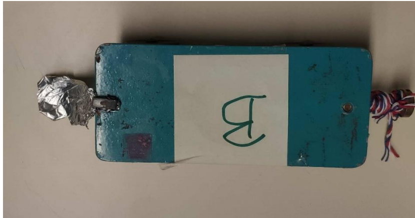
Slika 4.6 Spajanje vodljive vrpce na kolica
