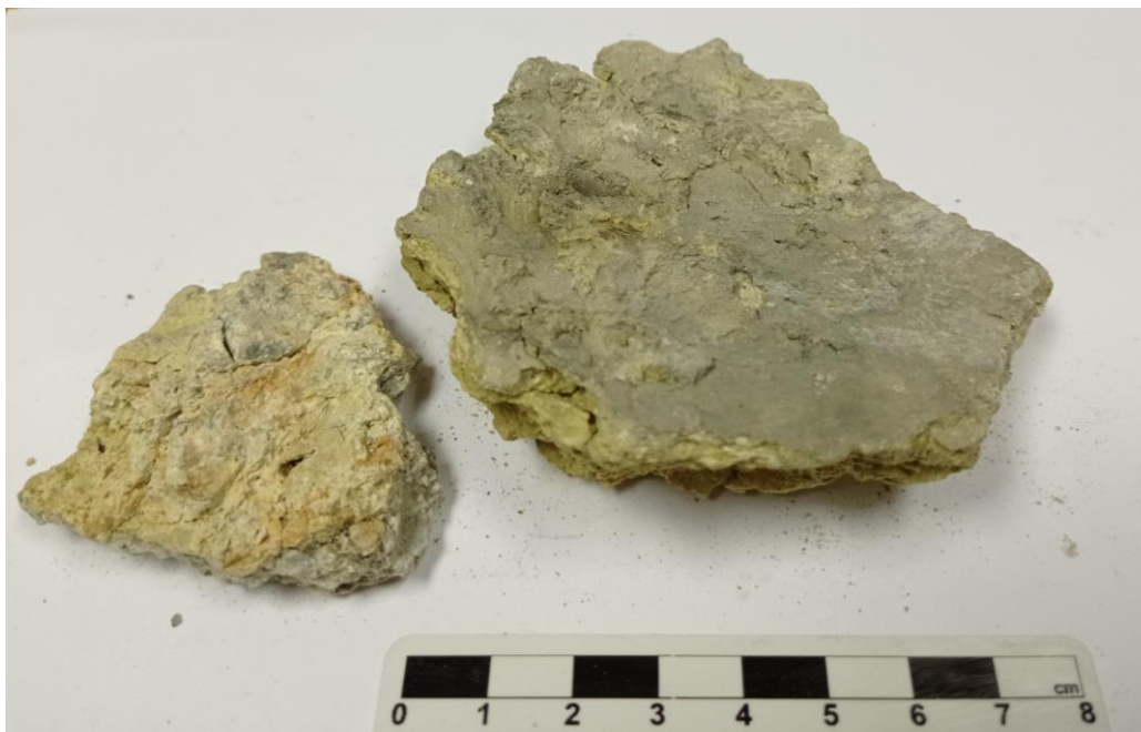
Slika 25. U uzorku Bz9 vidljiva je bijela faza (lijevo) i siva faza ispod koje se nazire zelena faza (desno).
