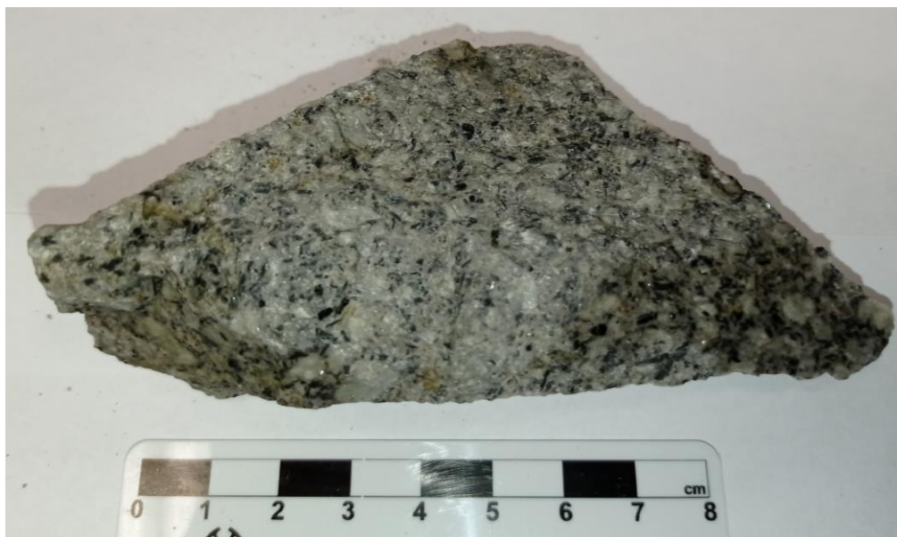
Slika 27. Uzorak Bz11 pokazuje tipičnu porfirnu strukturu.
