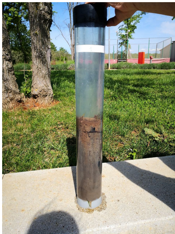
Slika 10: Priprema uzoraka, prikupljanje sedimenta pomoću plastičnog korera.
