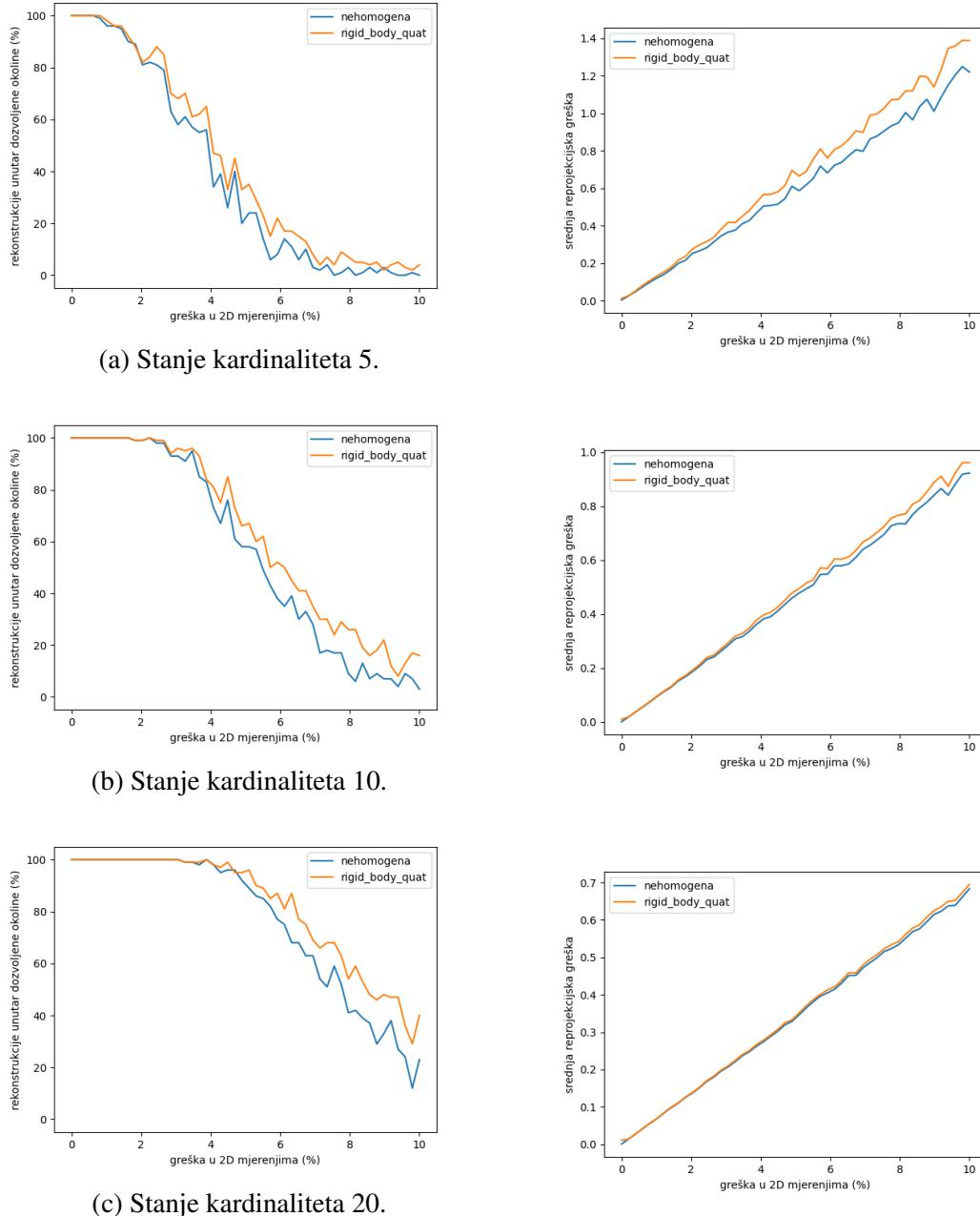
Slika 5.6: Rezultati testa otpornosti metode gradijentnog spusta s parametrizacijom kvaternionima na pogrešku u mjerenuju s kardinalitetima stanja 5, 10 i 20. Metrika  $m_2$  prikazana je u lijevom stupcu, a srednja reproduksijska greška u desnom.
