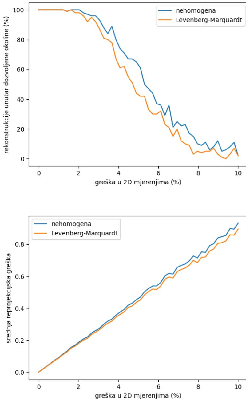
Slika 5.5: Otpornost nehomogene i Löwenberg-Marquardtovе metode sa 100 koraka na pogrešku u procjeni lokacije ključnih točaka u dvodimenzionalnom prostoru (lijevo) i srednja reprojekcijska pogreška rekonstruiranih objekata ovisno o metodi i pogrešci u dvodimenzionalnom prostoru (desno).
