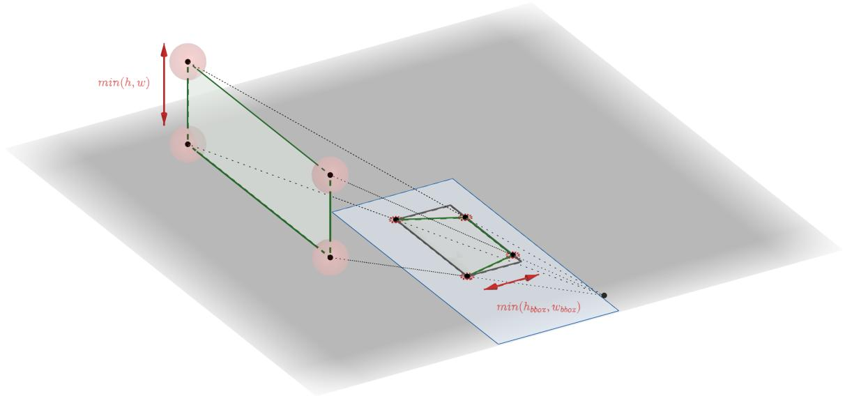
Slika 5.2: Dopuštena greška u trodimenzionalnoj reprodukciji i procijenjena (a zatim i inducirana, kako je opisano u 5.1) greška u dvodimenzionalnim mjerjenjima definirane su u terminima postotka minimuma visine i širine stvarnog objekta u 3D slučaju, tj. minimuma visine i širine projekcije opisanog pravokutnika (ozn.  $bbox$ , eng. *bounding box*) u 2D slučaju).
