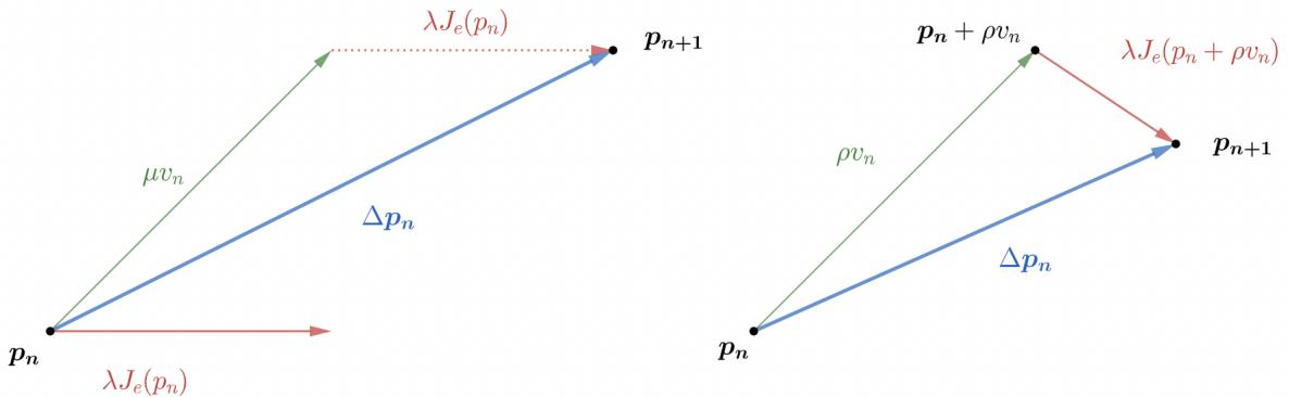
Slika 1.5: Usporedba ažuriranja parametara kod klasičnog (lijevo) i Nesterovog momenta (desno). [1]
