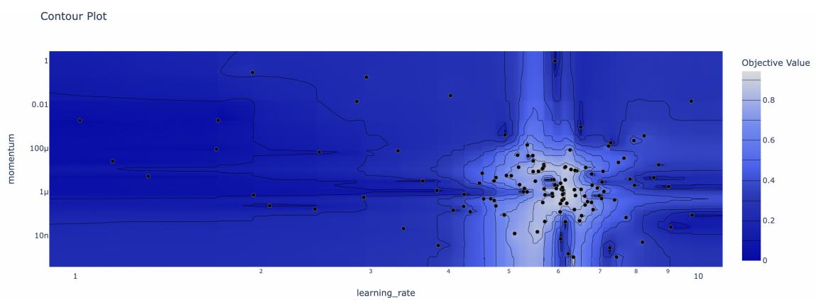
Slika 5.3: Primjer contour plota vrijednosti optimizacijskog cilja u ovisnosti o parametrima optimizatora (moment eng. *momentum* i stopa učenja eng. *learning rate* tj. parametar  $\lambda$  gradijentnog spusta). Točke označavaju izvedene eksperimente.
