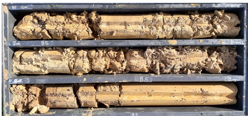
Slika 11. Bušotina B5, 6-9 m dubine.
