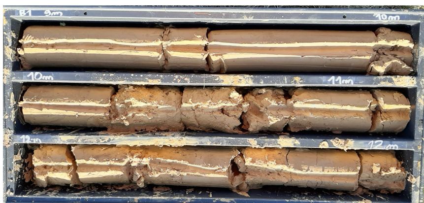
Slika 8. Bušotina B1, 9-12 m dubine.
