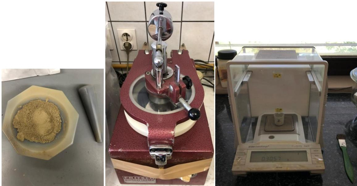
**Slika 14.** Znanstvena oprema koristena za pripremu uzorka za kalcimetriju; ahatni tarionik (lijevo), ahatni mlin Fritsch Pulverisette® (sredina), analitička vaga Mettler Toledo AT261 DeltaRange® (desno); Mineraloško-petrografska zavod PMF-a.
