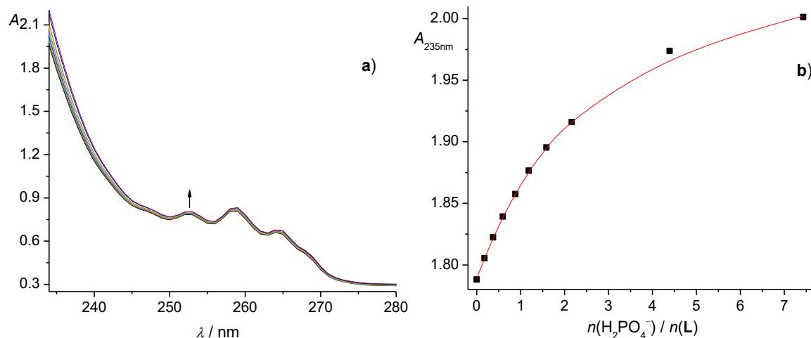
Slika 39. a) Spektrofotometrijska titracija spoja **L** ( $c = 4,58 \times 10^{-4} \text{ mol dm}^{-3}$ ) s  $\text{TBAH}_2\text{PO}_4$  ( $c = 6,19 \times 10^{-3} \text{ mol dm}^{-3}$ ) u metanolu pri  $25^\circ\text{C}$ . b) Ovisnost apsorbancije o množinskom omjeru  $n(\text{H}_2\text{PO}_4^-) / n(\text{L})$ . ■ izmjerene vrijednosti; — izračunate vrijednosti.
