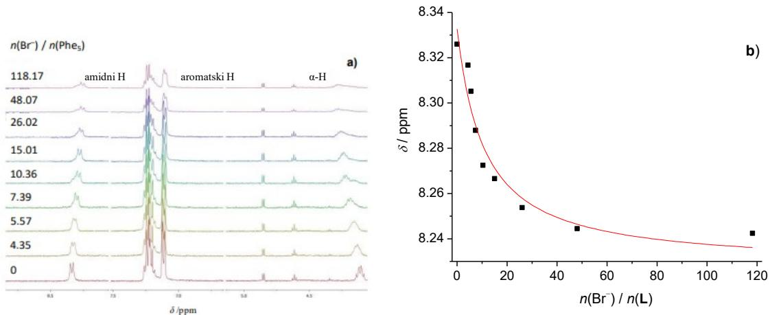
**Slika 48.** a)  $^1\text{H}$  NMR titracija spoja **L** ( $c = 4,80 \times 10^{-4}$  mol dm $^{-3}$ ) s TBABr ( $c = 0,151$  mol dm $^{-3}$ ) u deuteriranom DMSO-u pri 25 °C. b) Ovisnost kemijskog pomaka amidnog protona o množinskom omjeru  $n(\text{Br}^-) / n(\text{L})$ . ■ izmjerene vrijednosti, — izračunate vrijednosti.
