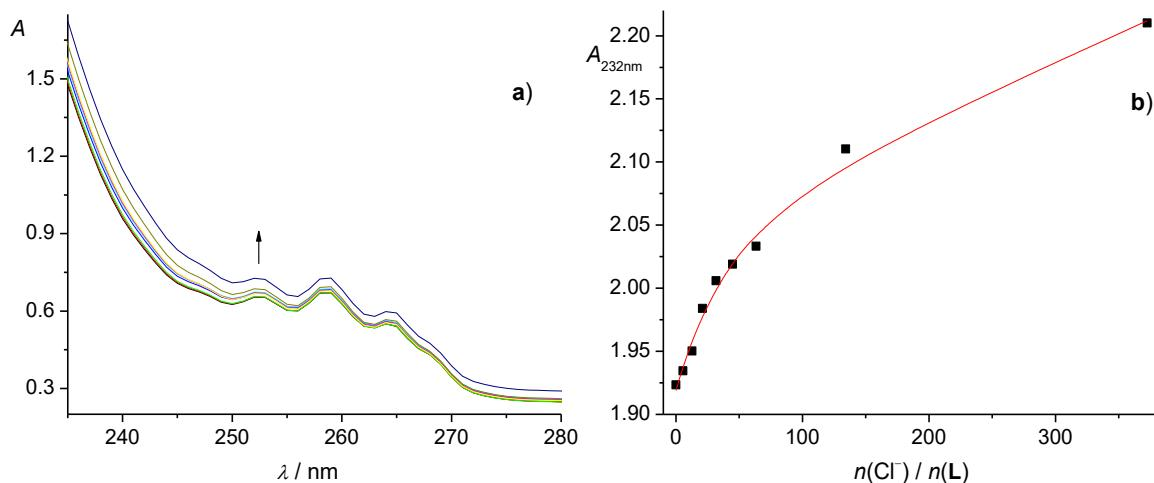
Slika 37. a) Spektrofotometrijska titracija spoja **L** ( $c = 4,04 \times 10^{-4} \text{ mol dm}^{-3}$ ) s TEACl ( $c = 0,301 \text{ mol dm}^{-3}$ ) u metanolu pri  $25^\circ\text{C}$ . b) Ovisnost apsorbancije o množinskom omjeru  $n(\text{Cl}^-) / n(\text{L})$ . ■ izmjerene vrijednosti; — izračunate vrijednosti.
