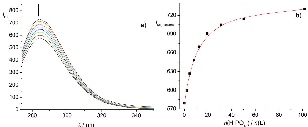
**Slika 36.** a) Fluorimetrijska titracija spoja **L** ( $c = 5,09 \times 10^{-5} \text{ mol dm}^{-3}$ ) s  $\text{TBAH}_2\text{PO}_4$  ( $c = 0,012 \text{ mol dm}^{-3}$ ) u metanolu pri  $25^\circ\text{C}$ .  $\lambda_{\text{ex}} = 260 \text{ nm}$ , eksitacijski prorez = 10 nm, emisijski prorez = 10 nm. b) Ovisnost relativnog intenziteta fluorescencije o množinskom omjeru  $n(\text{H}_2\text{PO}_4^-) / n(\text{L})$ . ■ izmjerene vrijednosti; — izračunate vrijednosti.
