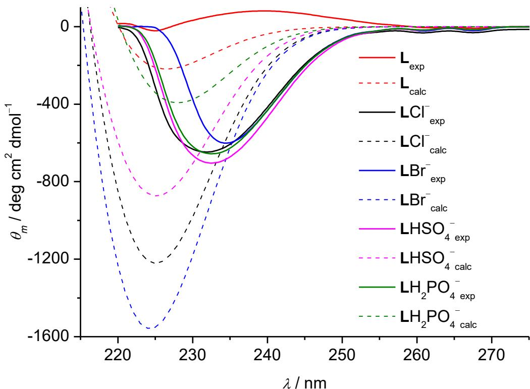
**Slika 31.** Eksperimentalni i izračunati CD spektri slobodnog spoja **L** u kompleksa s  $\text{Cl}^-$ ,  $\text{Br}^-$ ,  $\text{HSO}_4^-$  i  $\text{H}_2\text{PO}_4^-$  u acetonitrilu pri  $25^\circ\text{C}$ .
