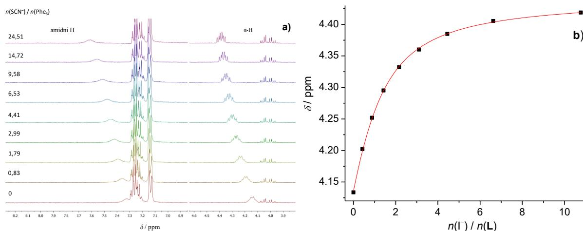
**Slika 26.** a) <sup>1</sup>H NMR titracija spoja **L** ( $c = 4,19 \times 10^{-4}$  mol dm<sup>-3</sup>) s TBASCN ( $c = 0,0178$  mol dm<sup>-3</sup>) u deuteriranom acetonitrilu pri 25 °C. b) Ovisnost kemijskog pomaka  $C_\alpha$  protona o množinskom omjeru  $n(\text{SCN}^-) / n(\text{L})$ . ■ izmjerene vrijednosti, — izračunate vrijednosti.
