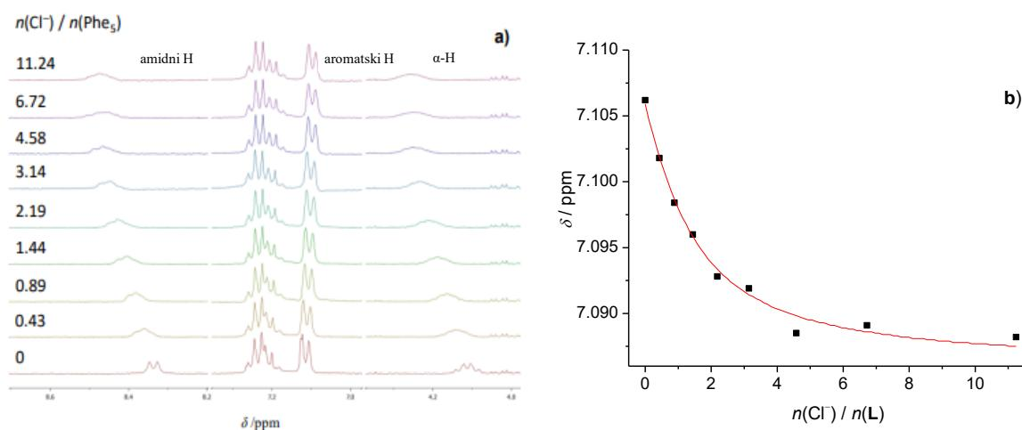
**Slika 47.** a)  $^1\text{H}$  NMR titracija spoja **L** ( $c = 4,26 \times 10^{-4}$  mol dm $^{-3}$ ) s TEACl ( $c = 9,41 \times 10^{-3}$  mol dm $^{-3}$ ) u deuteriranom DMSO-u pri 25 °C. b) Ovisnost kemijskog pomaka aromatskog protona o množinskom omjeru  $n(\text{Cl}^-) / n(\text{L})$ . ■ izmjerene vrijednosti, — izračunate vrijednosti.
