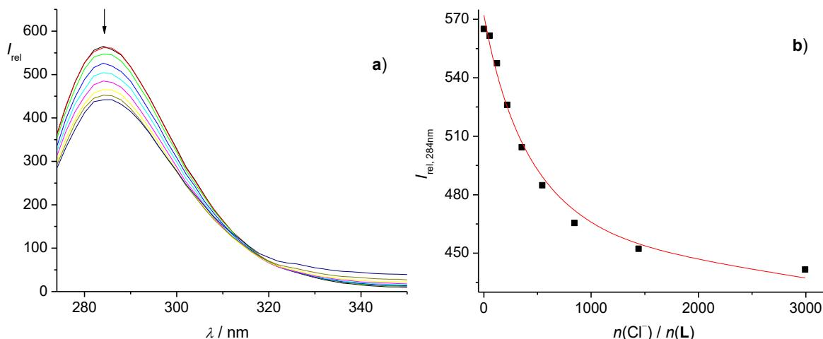
**Slika 34.** a) Fluorimetrijska titracija spoja **L** ( $c = 5,10 \times 10^{-5}$  mol dm $^{-3}$ ) s TEACl ( $c = 0,308$  mol dm $^{-3}$ ) u metanolu pri 25 °C.  $\lambda_{\text{ex}} = 260$  nm, eksitacijski prorez = 10 nm, emisijski prorez = 10 nm. b) Ovisnost relativnog intenziteta fluorescencije o množinskom omjeru  $n(\text{Cl}^-) / n(\text{L})$ . ■ izmjerene vrijednosti; — izračunate vrijednosti.
