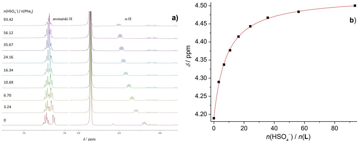
**Slika 41.** a)  $^1\text{H}$  NMR titracija spoja **L** ( $c = 4,42 \times 10^{-4} \text{ mol dm}^{-3}$ ) s TBAHSO<sub>4</sub> ( $c = 0,0809 \text{ mol dm}^{-3}$ ) u deuteriranom metanolu pri  $25^\circ\text{C}$ . b) Ovisnost kemijskog pomaka  $\text{C}_\alpha$  protona o množinskom omjeru  $n(\text{HSO}_4^-) / n(\text{L})$ . ■ izmjerene vrijednosti, — izračunate vrijednosti.
