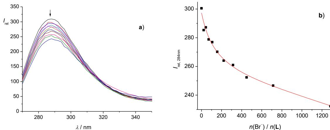
**Slika 46.** a) Fluorimetrijska titracija spoja **L** ( $c = 4,57 \times 10^{-5} \text{ mol dm}^{-3}$ ) s TBABr ( $c = 1,50 \times 10^{-2} \text{ mol dm}^{-3}$ ) u DMSO–u pri  $25^\circ\text{C}$ .  $\lambda_{\text{ex}} = 260 \text{ nm}$ , eksitacijski prorez = 10 nm, emisijski prorez = 10 nm. b) Ovisnost relativnog intenziteta fluorescencije o množinskom omjeru  $n(\text{Br}^-) / n(\text{L})$ .
