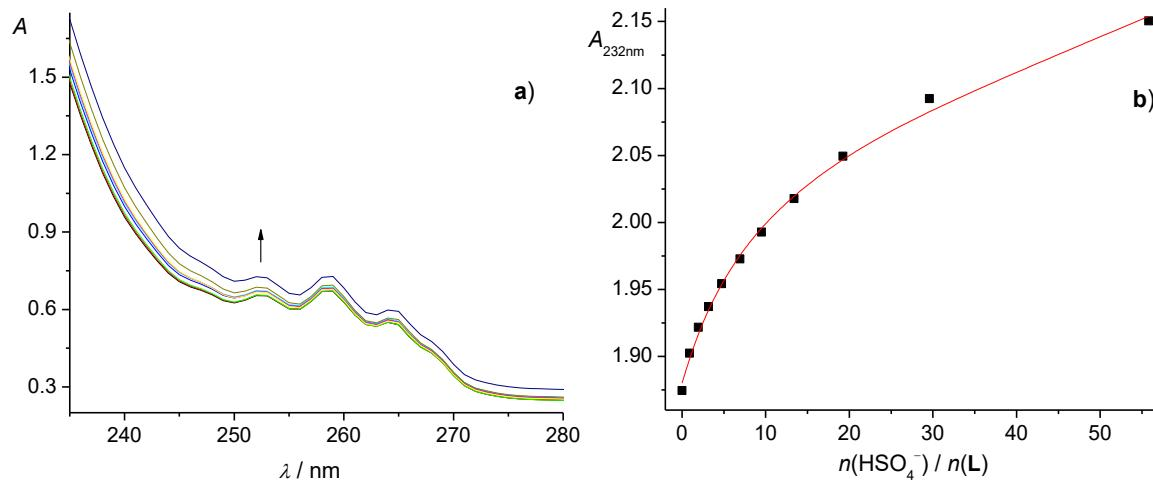
Slika 38. a) Spektrofotometrijska titracija spoja **L** ( $c = 4,04 \times 10^{-4} \text{ mol dm}^{-3}$ ) s  $\text{TBAHSO}_4$  ( $c = 0,0451 \text{ mol dm}^{-3}$ ) u metanolu pri  $25^\circ\text{C}$ . b) Ovisnost apsorbancije o množinskom omjeru  $n(\text{HSO}_4^-) / n(\text{L})$ . ■ izmjerene vrijednosti; — izračunate vrijednosti.
