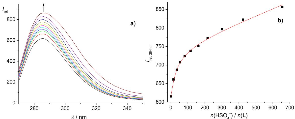
**Slika 35.** a) Fluorimetrijska titracija spoja **L** ( $c = 5,09 \times 10^{-5} \text{ mol dm}^{-3}$ ) s  $\text{TBAHSO}_4$  ( $c = 0,0903 \text{ mol dm}^{-3}$ ) u metanolu pri  $25^\circ\text{C}$ .  $\lambda_{\text{ex}} = 260 \text{ nm}$ , eksitacijski prorez = 10 nm, emisijski prorez = 10 nm. b) Ovisnost relativnog intenziteta fluorescencije o množinskom omjeru  $n(\text{HSO}_4^-) / n(\text{L})$ . ■ izmjerene vrijednosti; — izračunate vrijednosti.
