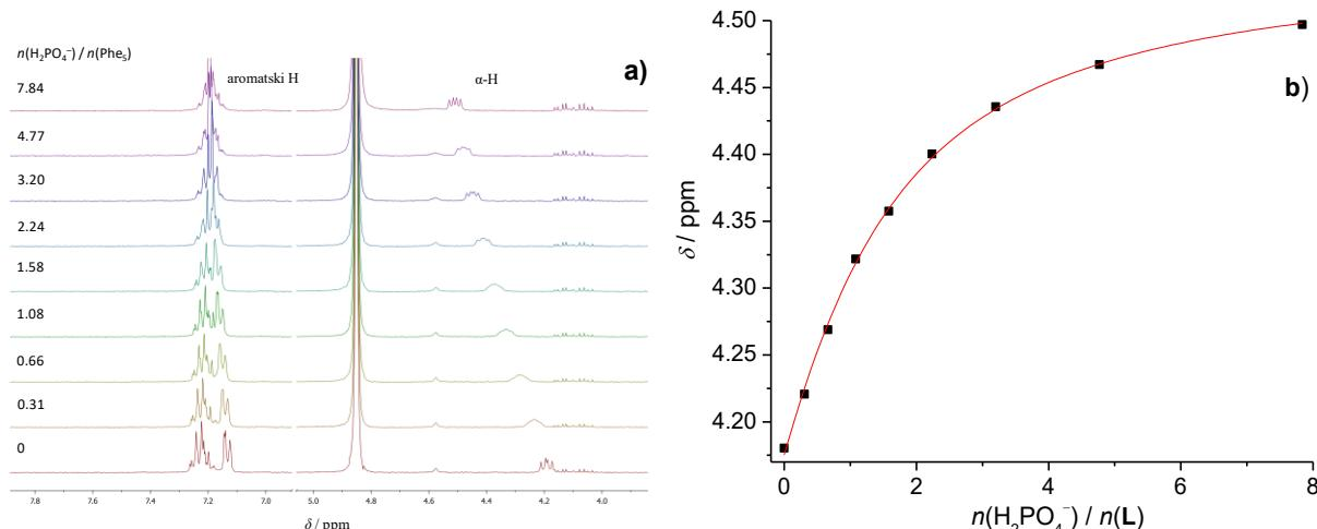
Slika 42. a)  $^1\text{H}$  NMR titracija spoja **L** ( $c = 4,19 \times 10^{-4}$  mol dm<sup>-3</sup>) s TBAH<sub>2</sub>PO<sub>4</sub> ( $c = 6,58 \times 10^{-3}$  mol dm<sup>-3</sup>) u deuteriranom metanolu pri 25 °C. b) Ovisnost kemijskog pomaka  $\text{C}_\alpha$  protona o množinskom omjeru  $n(\text{H}_2\text{PO}_4^-)$  /  $n(\text{L})$ . ■ izmjerene vrijednosti, — izračunate vrijednosti.
