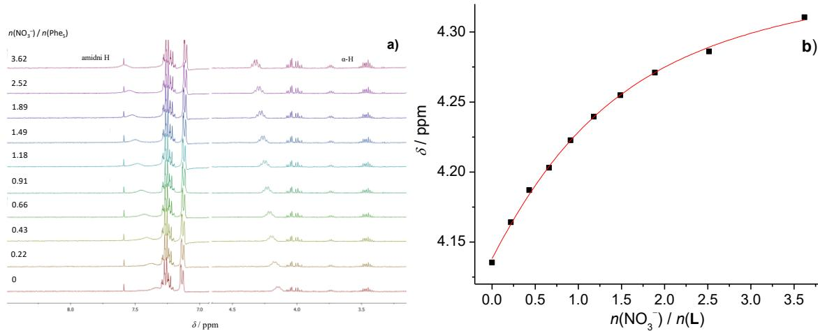
**Slika 25.** a)  $^1\text{H}$  NMR titracija spoja **L** ( $c = 4,26 \times 10^{-4} \text{ mol dm}^{-3}$ ) s  $\text{TBANO}_3$  ( $c = 2,67 \times 10^{-3} \text{ mol dm}^{-3}$ ) u deuteriranom acetonitrilu pri  $25^\circ\text{C}$ . b) Ovisnost kemijskog pomaka  $\text{C}_\alpha$  protona o množinskom omjeru  $n(\text{NO}_3^-) / n(\text{L})$ . ■ izmjerene vrijednosti, — izračunate vrijednosti.
