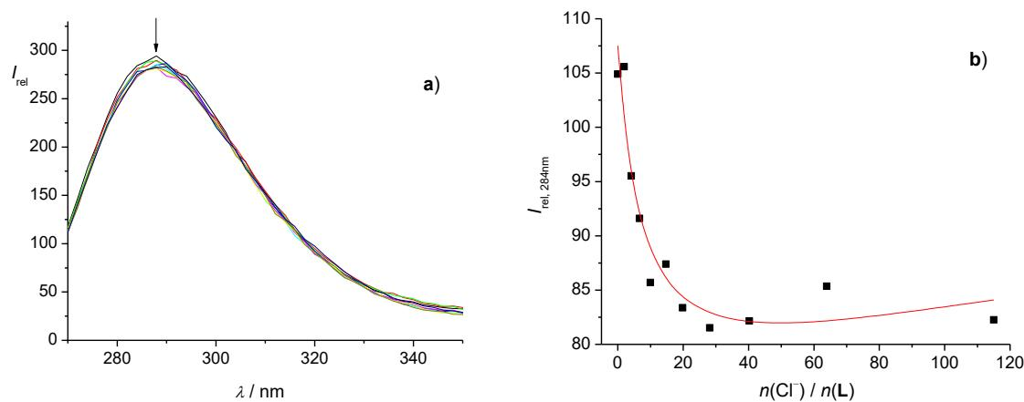
**Slika 45.** a) Fluorimetrijska titracija spoja **L** ( $c = 5.20 \times 10^{-5} \text{ mol dm}^{-3}$ ) s TEACl ( $c = 0,0153 \text{ mol dm}^{-3}$ ) u DMSO–u pri  $25^\circ\text{C}$ .  $\lambda_{\text{ex}} = 260 \text{ nm}$ , eksitacijski prorez = 10 nm, emisijski prorez = 10 nm. b) Ovisnost relativnog intenziteta fluorescencije o množinskom omjeru  $n(\text{Cl}^-) / n(\text{L})$ .
