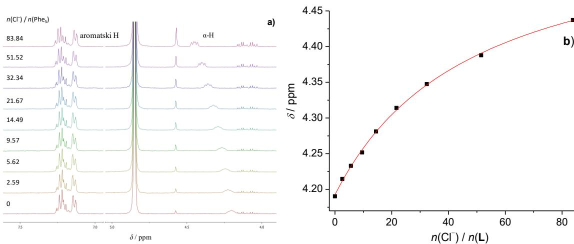
**Slika 40.** a)  $^1\text{H}$  NMR titracija spoja **L** ( $c = 4,80 \times 10^{-4} \text{ mol dm}^{-3}$ ) s TEACl ( $c = 0,0702 \text{ mol dm}^{-3}$ ) u deuteriranom metanolu pri  $25^\circ\text{C}$ . b) Ovisnost kemijskog pomaka  $\text{C}_\alpha$  protona o množinskom omjeru  $n(\text{Cl}^-) / n(\text{L})$ . ■ izmjerene vrijednosti, — izračunate vrijednosti.
