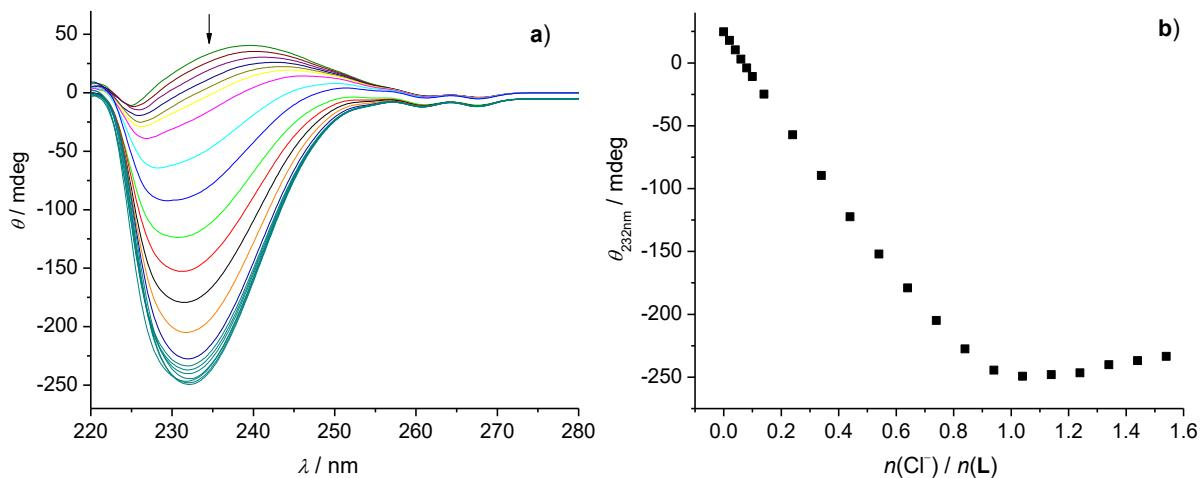
**Slika 27.** a) CD titracija spoja **L** ( $c = 5,00 \times 10^{-4}$  mol dm $^{-3}$ ) s TEACl ( $c = 2,00 \times 10^{-3}$  mol dm $^{-3}$ ) u acetonitrilu pri 25 °C. b) Ovisnost eliptičnosti o množinskom omjeru  $n(\text{Cl}^-) / n(\text{L})$ . ■ izmjerene vrijednosti.
