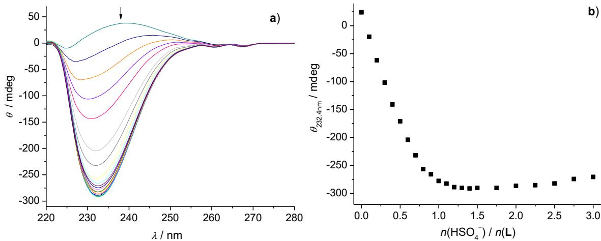
**Slika 29.** a) CD titracija spoja **L** ( $c = 5,00 \times 10^{-4}$  mol dm $^{-3}$ ) s TBAHSO $_4$  ( $c = 5,00 \times 10^{-3}$  mol dm $^{-3}$ ) u acetonitrilu pri 25 °C. b) Ovisnost eliptičnosti o množinskom omjeru  $n(\text{HSO}_4^-)$  /  $n(\text{L})$ . ■ izmjerene vrijednosti.
