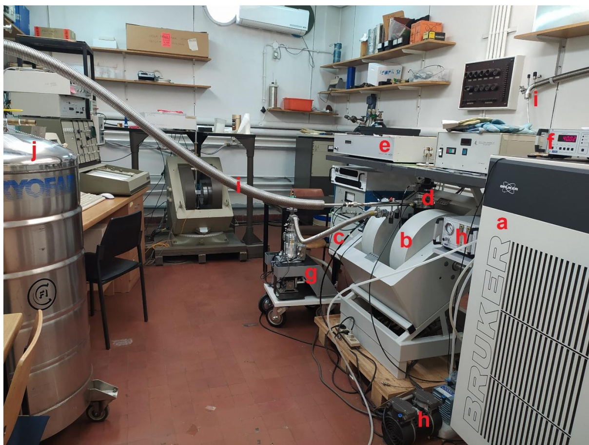
Slika 18. EPR spektrometar Bruker Eleksys 580 FT/CW u Laboratoriju za magnetske rezonancije Instituta Ruđer Bošković u Zagrebu. Na slici su označeni dijelovi spektrometra.
