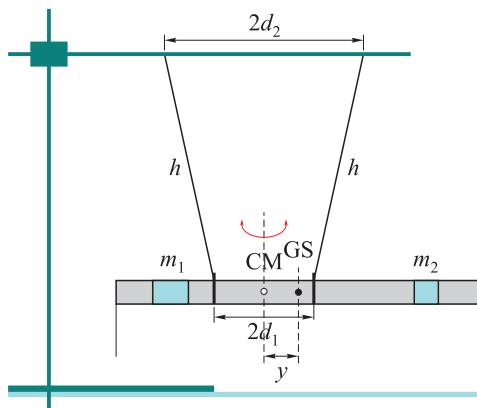
Aluminijsku cijev ovjesite kao bifilarno njihalo i ramotrite torzionate oscilacije cijevi. Niti pomoću kojih se cijev treba ovjesiti treba simetrično zavezati s obje strane centra mase, koje prethodno treba odrediti. Gornje krajeve niti zatim učvrstite pomoću vezica na šipku postavljenu na stativ, tako da možete mijenjati razmak između ovjesišta.
