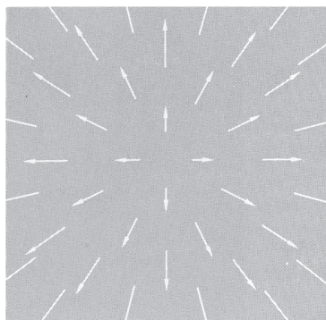
Slika 4. Primjer vala \psi(\vec{r}) = \psi_x(\vec{r}) + i\psi_y(\vec{r}) u dvodimenzionalnom prostoru \vec{r} = x\vec{i} + y\vec{j} . Vektori prikazuju \psi = \vec{i}\psi_x + \vec{j}\psi_y . Izabran je \psi s virom u x = y = 0 .
