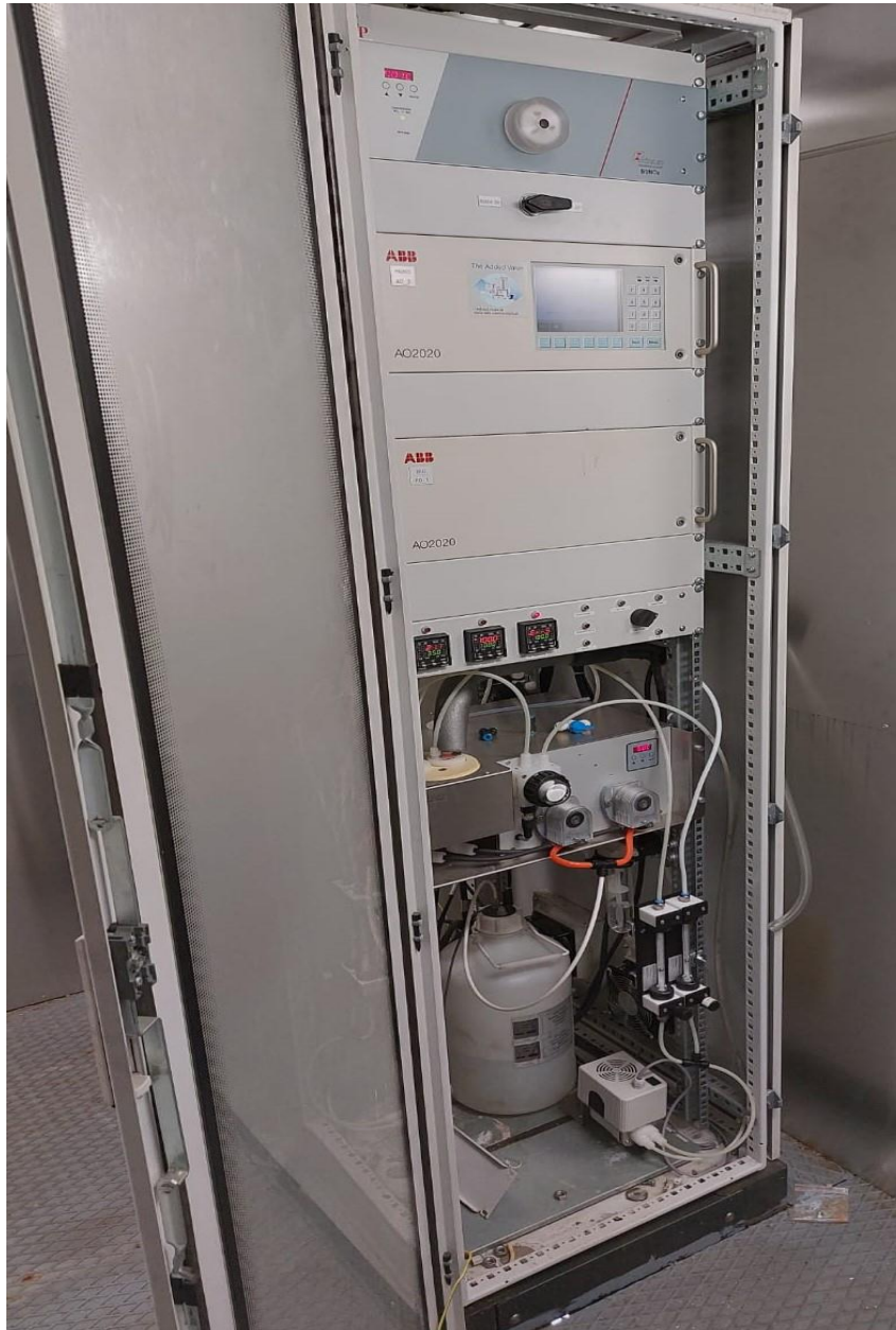
Sl. 7. Uređaj za mjerenje emisija u zrak
