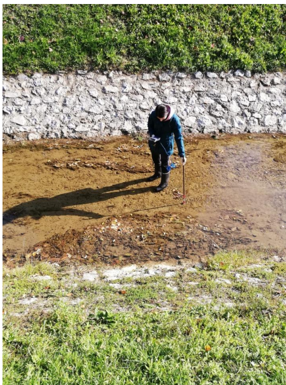
Slika 6. Mjerenje brzine strujanja vode na postaji V1 (Fotografija: doc. dr. sc. Mirela Sertić Perić)
