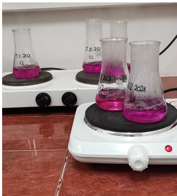
Slika 7. Određivanje količine otopljene organske tvari u uzorcima vode (Fotografija: Dunja Jurina)
