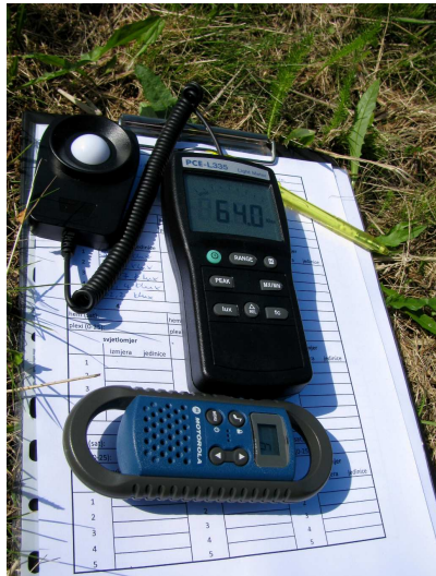
Slika 17. Svjetlomjer Light Meter PCE-L335 i Motorola prijenosni radio primopredajnik (walkie-talkie) (foto M. Miletić)
