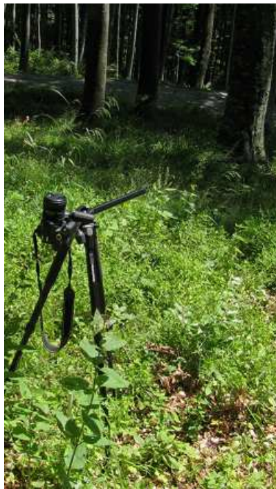
Slika 11. Fotoaparat s hemisfernim objektivom na tronošću (foto M. Miletić)
