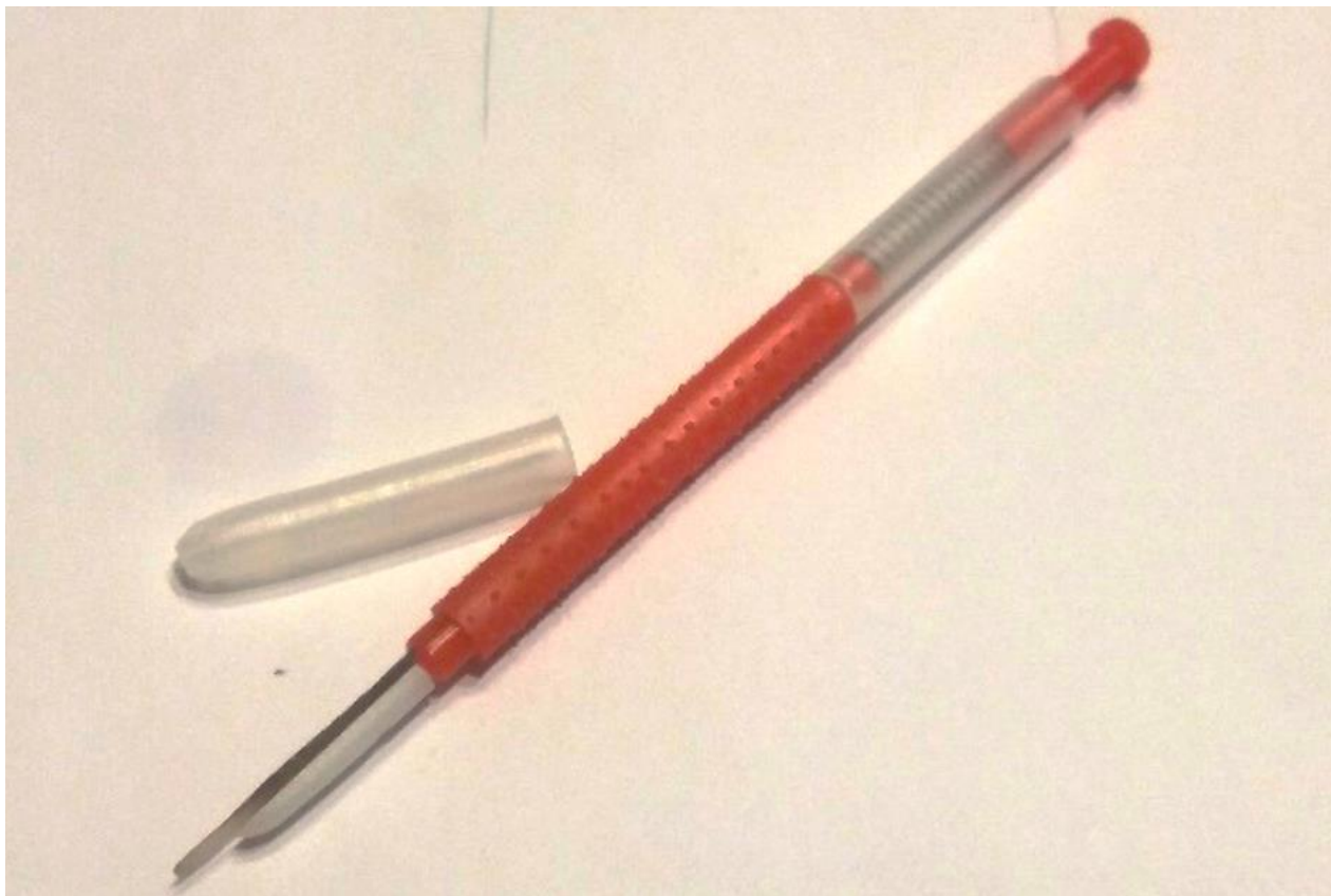
Slika 4. Fotografija plastične iglice za presađivanje (graft) ličinki pčela, pri uzgoju novih matica. Iglica radi na sistemu žličice za sakupljanje jajašaca i ličinki s pomičnim dijelom koji radi na bazi opruge. Cijeli alat funkcionira poput kemijske olovke te omogućuje lakše uzimanje i ispuštanje jajašaca i ličinki.
