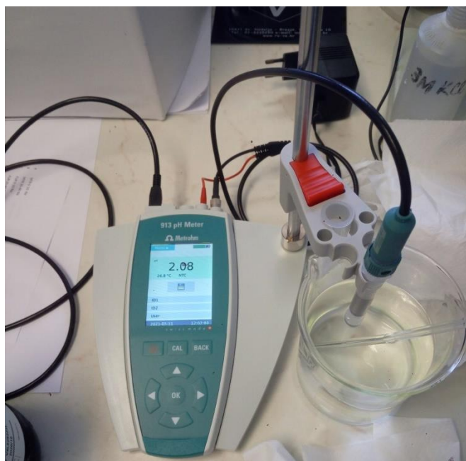
Slika 12. Mjerenje pH-metrom, Mineraloško-petrografski zavoda Geološkog odsjeka Prirodoslovno-matematički fakultet u Zagrebu.
