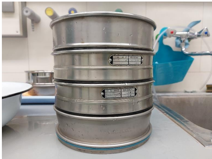
Slika 5. Četiri sita promjera mrežice 500, 250, 125 i 63 \mu m
