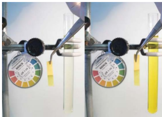
Slika 4. Fotografije otopina vanadata, pri sobnoj temperaturi, dobiven dekanadat pri koncentraciji 10 \text{ mmol L}^{-1} , pH 6.8, prije (lijevo) i nakon dodatka HCl (desno) pH 6.6 10 (Izvor: M. Aureliano, Dalton Trans , 2009, 42 , 9093)
