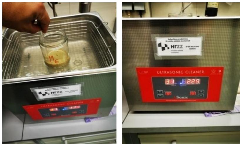
Slika 12. Potapanje uzorka u ultrazvučnoj kupki.
