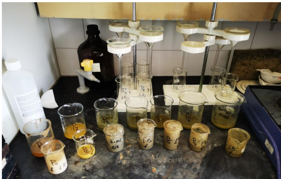
Slika 19. Uzorci frakcija i osnovnog materijala ostavljeni su 24 sata da otopina djeluje.
