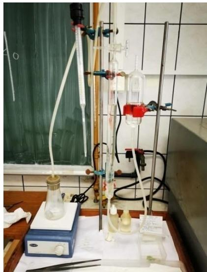
Slika 15. Scheiblerova aparatura za kalcimetriju.
