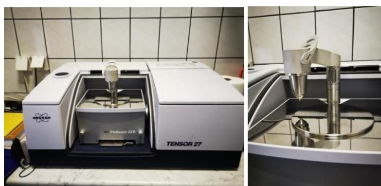
SLIKA 28. Infracrveni spektrometar BRUKER TENSOR 27.
