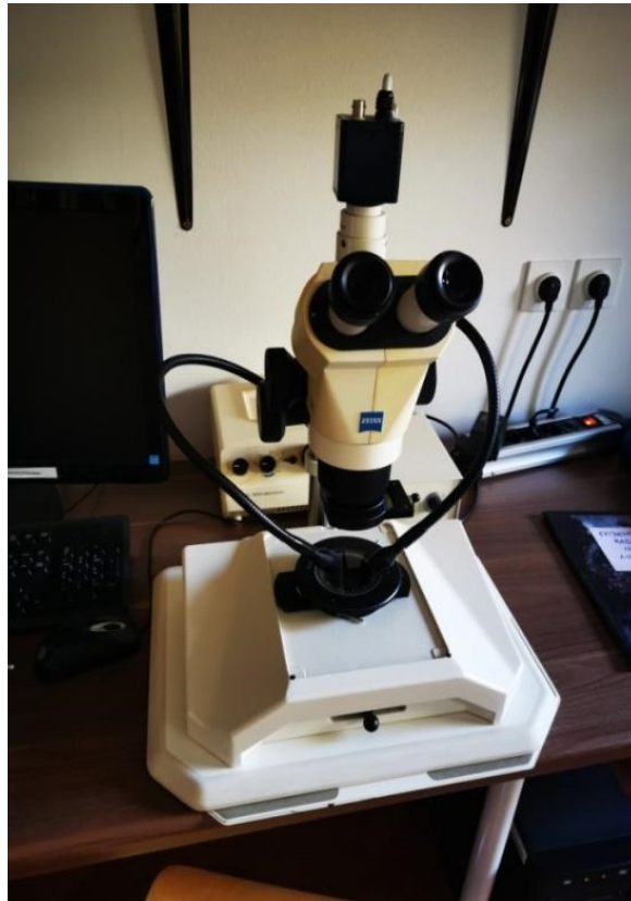
Slika 25. Polarizacijska istraživačka lupa Zeiss sa digitalnim sučeljem za snimanje mikrofotografija sa vanjskim sustavom svjetla. Mineralno-petrografski zavod PMF-a.
