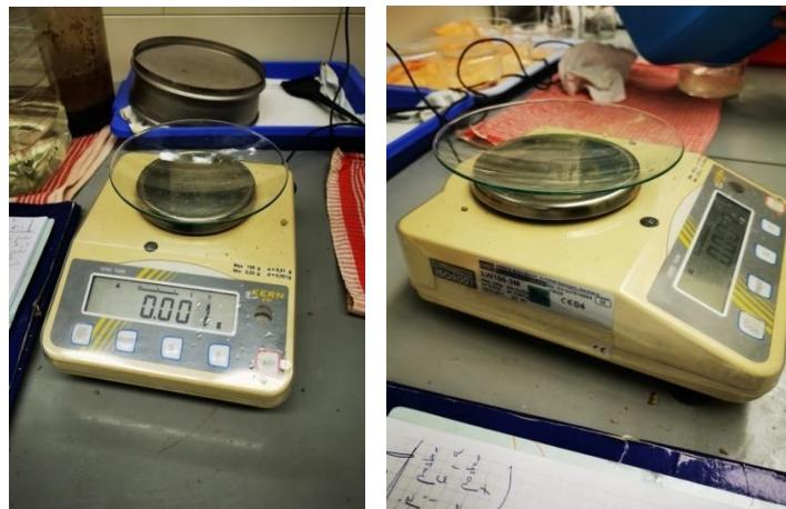
Slika 11. Vaga korištena za određivanje mase suhih uzoraka.
