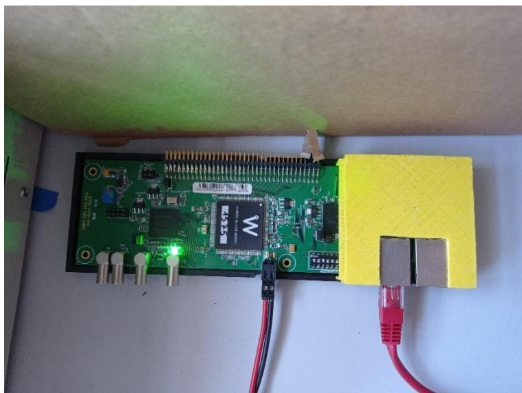
Slika 3.2 Caen A1702 mjerni uređaj
