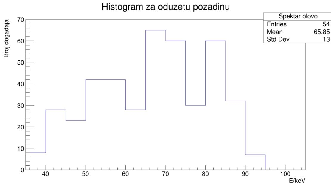
Slika 4.15 Uvećani dobiveni spektar olova snimljen u 30 minuta
