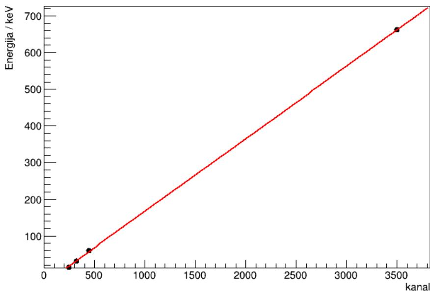
Slika 4.6 Kalibracijski pravac za mjerjenje od 30 minuta
