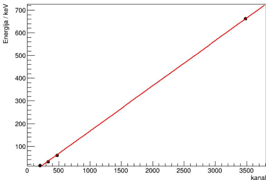
Slika 4.7 Kalibracijski pravac za mjerjenje od 60 minuta
