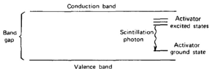
Slika 2.2 Energija struktura aktiviranog kristalnog scintilatora[6]
