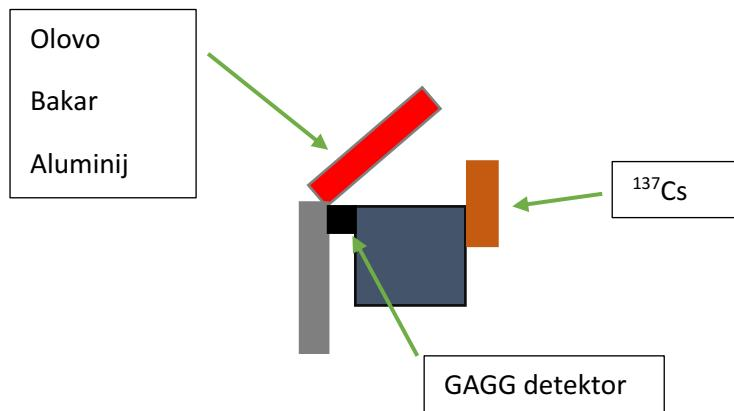
Ilustracija 4.3 ilustracija mjernog postava B sa raznim materijalima. Pravokutnik označen crvenom bojom predstavlja materijal koji je mijenjan za vrijeme mjerena.
