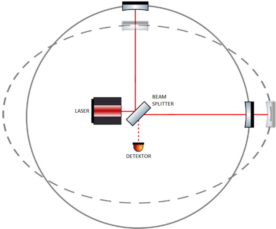
Slika 1.1: Skica interferometrijskog detektora gravitacijskih valova. [3]
