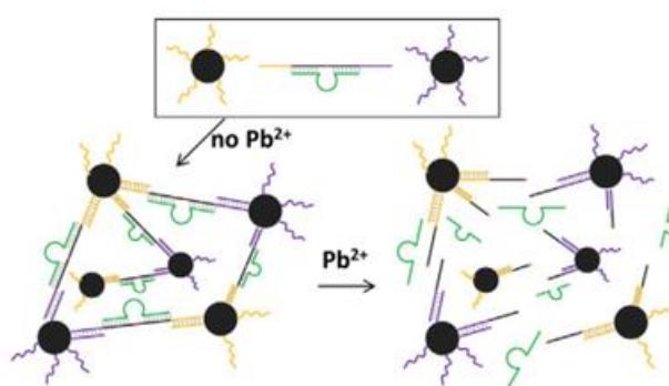
Slika 14. Nanočestice u kombinaciji s DNAzimom za detekciju  $Pb^{2+}$ . Preuzeto iz<sup>21</sup>
