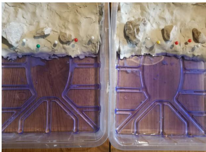
Slika 5.3.7 Kutije s glinom i vodom spremne za dodavanje leda
