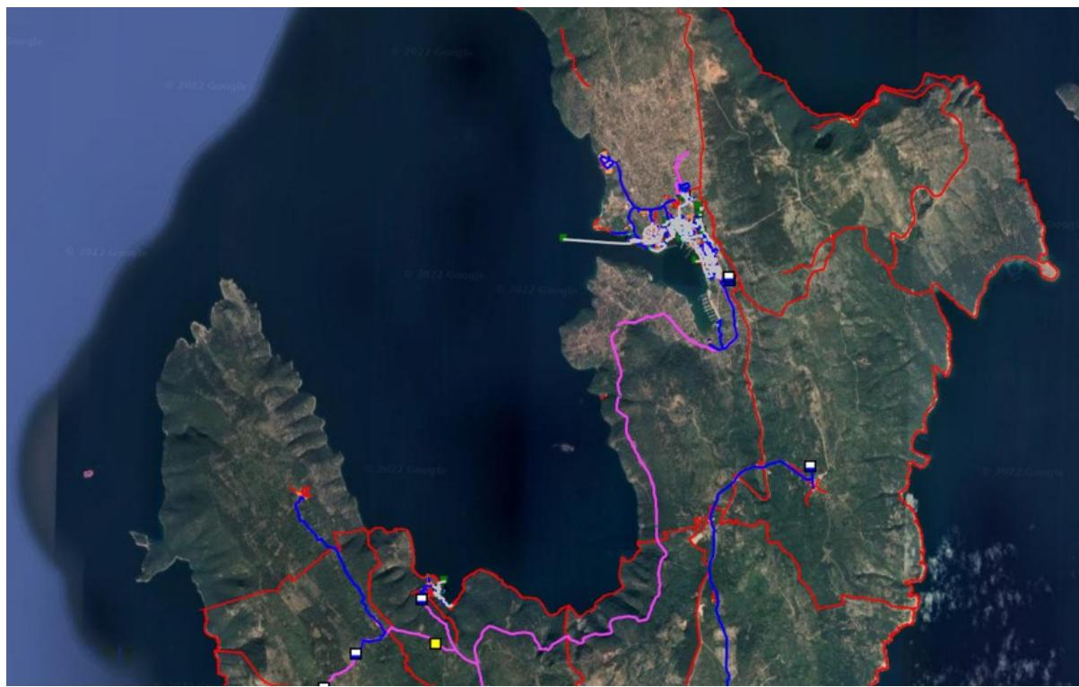
Slika 13. Kartografski prikaz vodovodnog sustava na području okolice Grada Cresa
